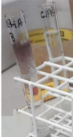
Figura 4.5. Comparação das alíquotas com a solução de nitrato de prata.
