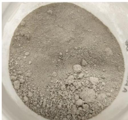
Figura 4.2. Amostra de calha pulverizada do reservatório Pré-sal.
