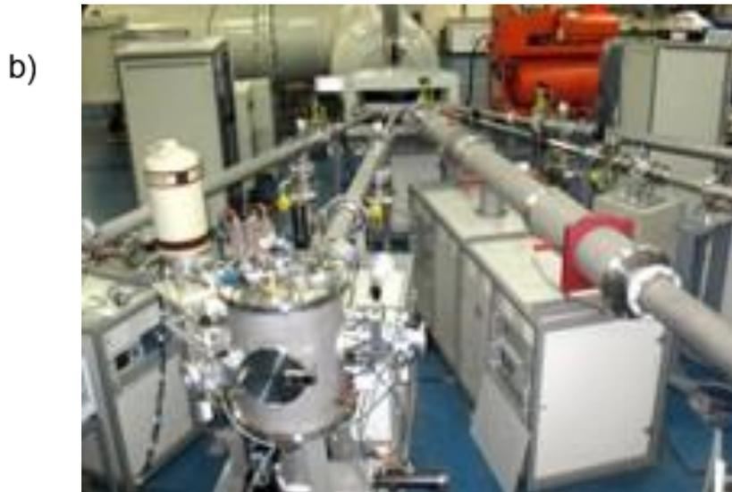
Figura. 3.5. a) etapas de aceleração e modulação do feixe no Tandem 3 MV; b) fotografia do acelerador, com as diferentes linhas de análise em evidência
