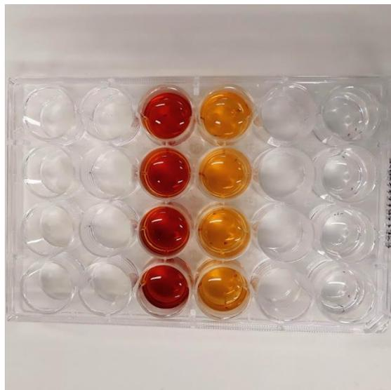
Figura. 4.3. Placa de poços usada no tratamento. As cores laranja e bordô das soluções de SPION-DX correspondem a, respectivamente, 2 e 8 mM de Fe.
