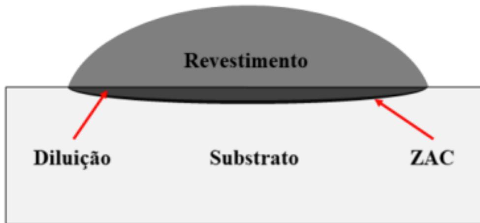
Figura 3.3.1.1. Principais regiões presentes em uma deposição por *laser cladding*. (Fonte: Sousa, 2019).
