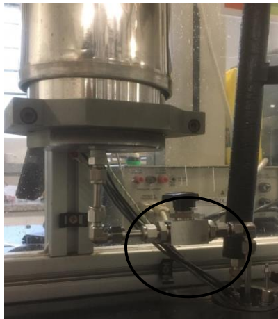
Válvula de bloqueio que libera a coleta das partículas.
