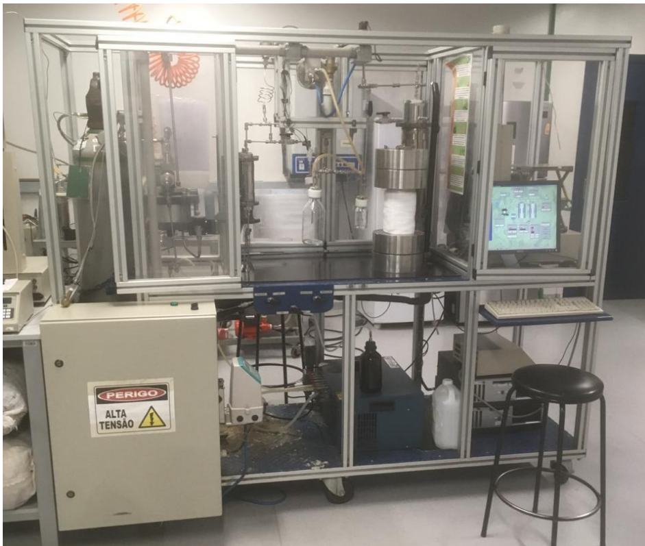
Figura 5.7 - Unidade híbrida de extração supercrítica e encapsulação pela tecnologia SAILA
