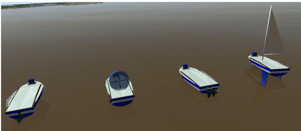
Figura 3.12: Da esquerda para direita: *rudder boat*, *airboat*, *differential boat* and *sailboat* disponibilizado no simulador.
