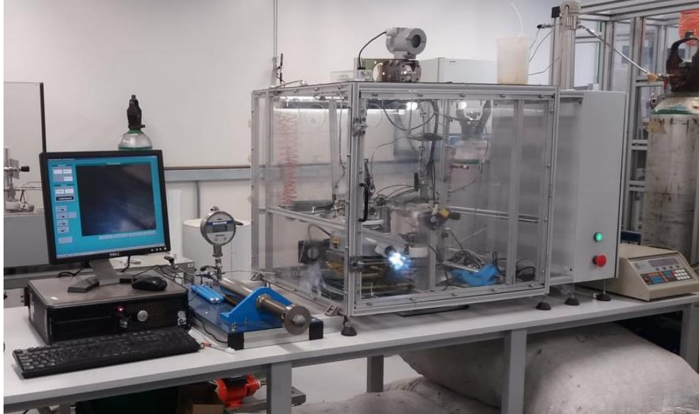
Figura 4.1. Foto do equipamento de esfoliação supercrítica onde foram realizadas as esfoliações do grafite.
