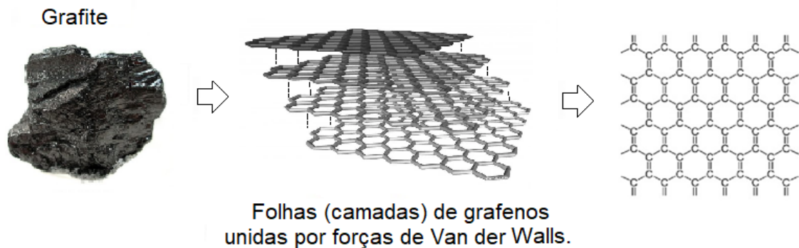
Figura 1.1. Empilhamento de folhas (camadas) de grafeno que constituem o grafite, adaptado de BBLOGGER, (2013).
