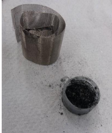
Figura 4.4. Porta amostra contendo grafite Grafine após sofrer a despressurização do CO 2 SC à 35°C
