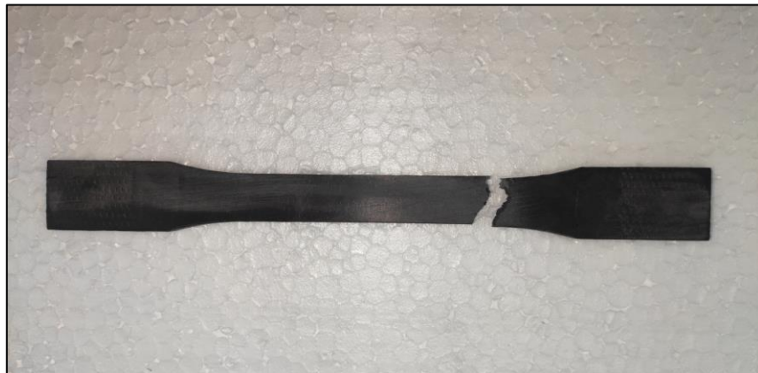
Figura 5.2. Corpo de prova fraturado após ensaio de tração.
