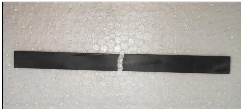
Figura 5.4. Corpo de prova após ensaio de flexão.
