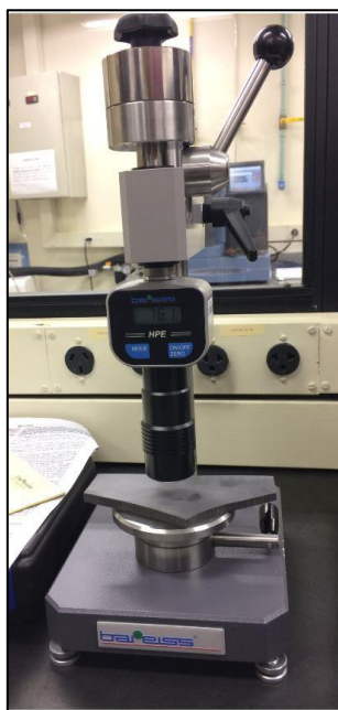
Figura 4.14. Realização do ensaio de dureza em durômetro Bareiss Shore D.
