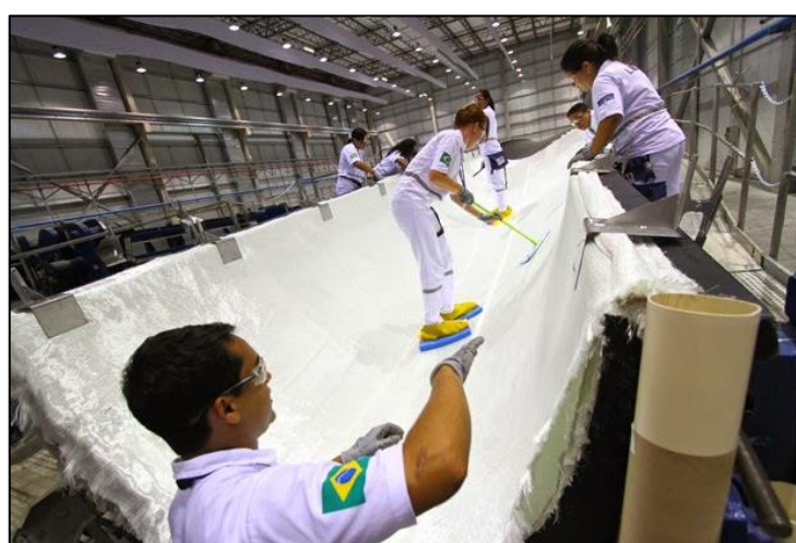
Figura 3.10. Deposição do tecido de fibra de vidro em um molde de pá de aerogerador de grande porte.
