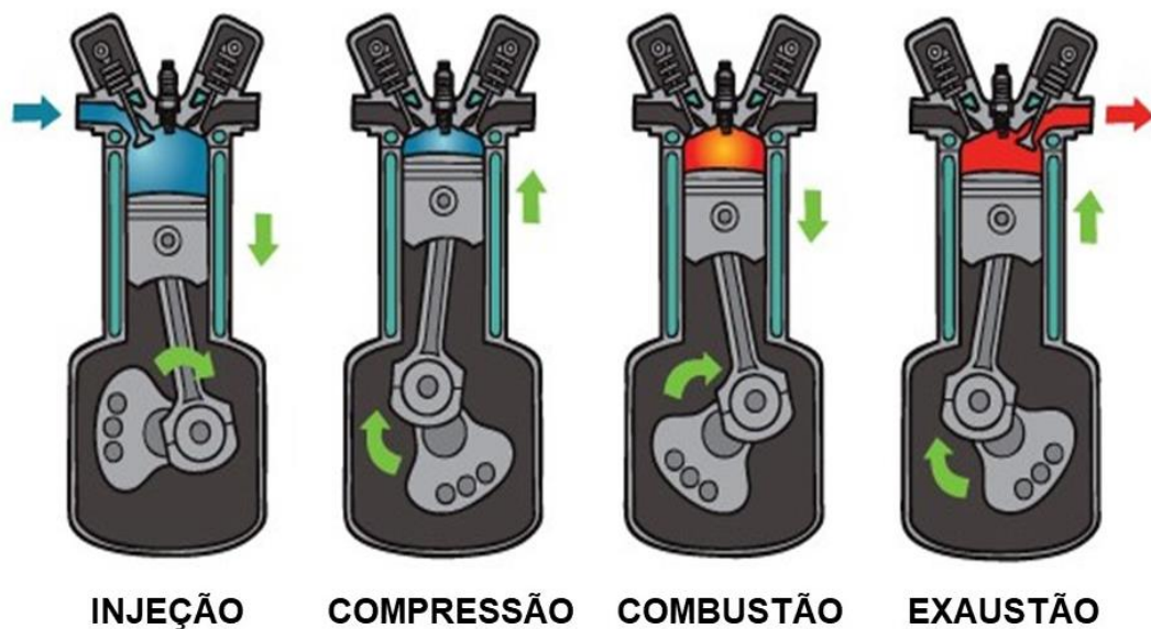
Figura 3.1. Funcionamento de um motor 4 tempos ciclo diesel.
