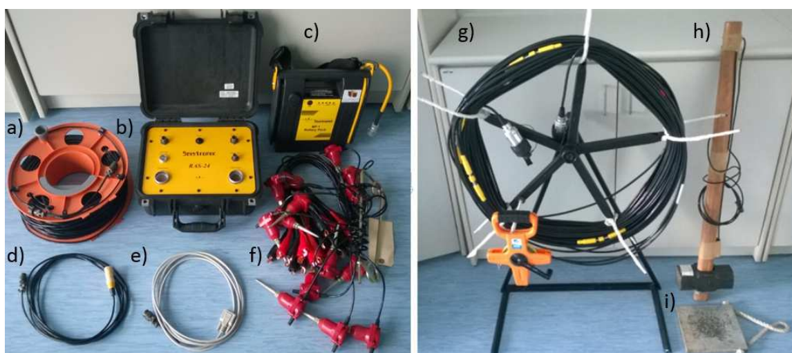
Figura 4.10: Partes componentes do sismógrafo multicanal. a) Extensão do disparador, b) RAS-24, c) bateria de 12 V, d) disparador e) cabo serial, f) 12 geofones, g) cabo de conexão dos geofones de 120 m, h) marreta de 8 kg e i) placa de alumínio.
