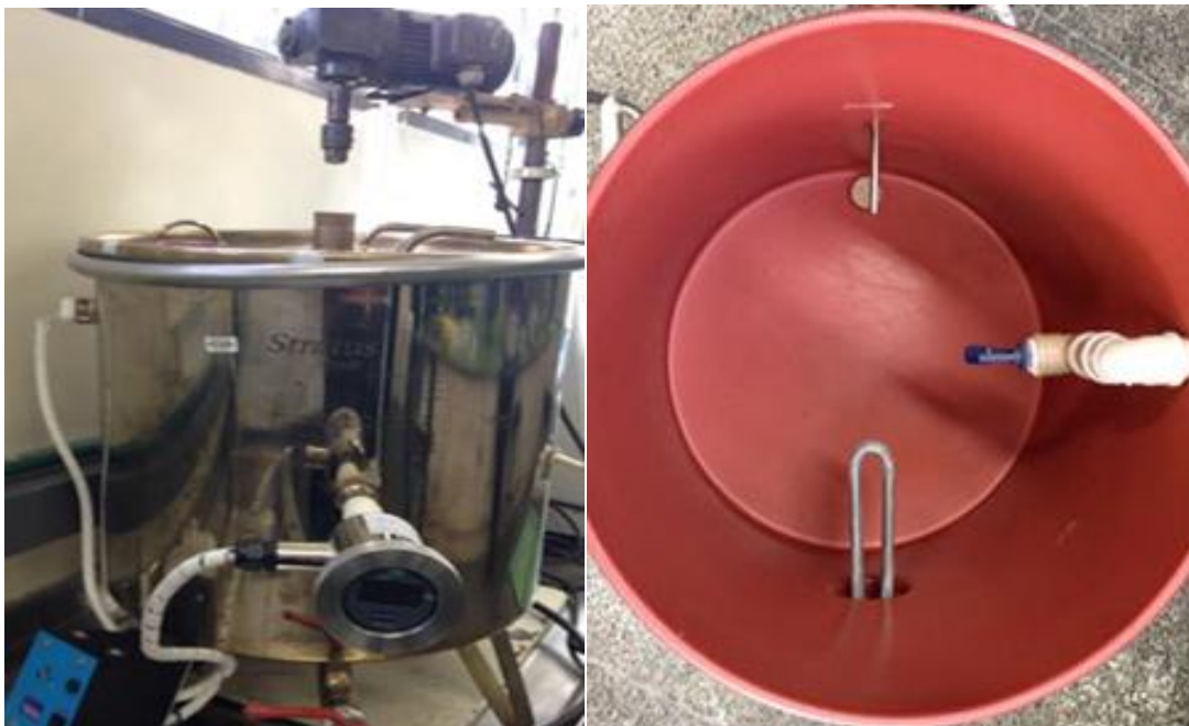
Figura 4.3. Reator B utilizado em extração e síntese de zeólitas em escala piloto, por método hidrotérmico.
