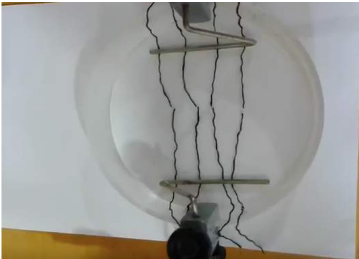
FIGURA 18. Alinhamento dos fios após aplicação do campo elétrico.
