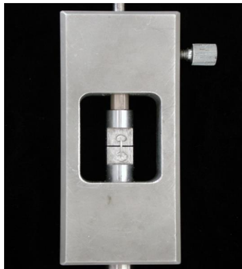
Figura 8: Matriz utilizada para o teste de microtração.
