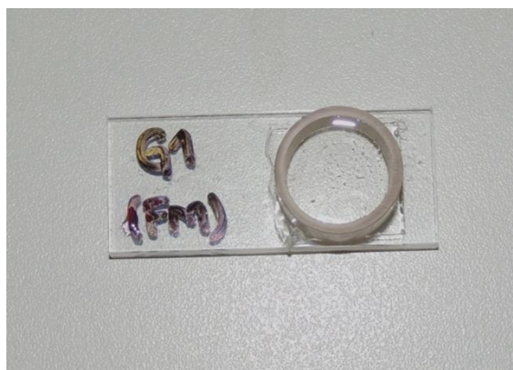
Figura 5: Matriz de PVC adaptado sobre a fita dupla face.
