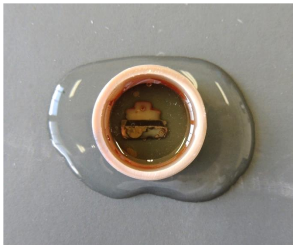
Figura 6: Amostra sobre lixa de granulação 1200 e água.
