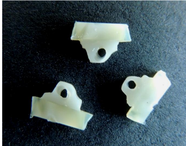
Figura 1: Perfuração da região de topo da resina composta com ponta diamantada 1010.
