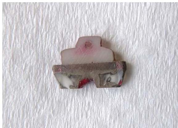
Figura 4: Fatia após remoção do esmalte com auxílio de lixa d'água.
