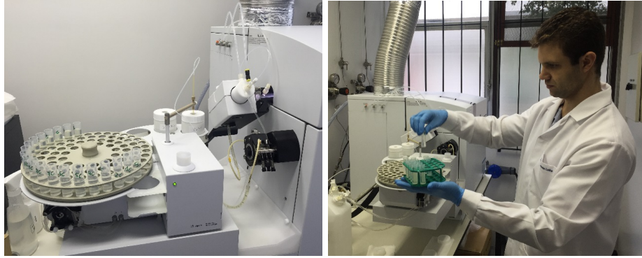
Figura 3. Realização da Espectrometria de massa com fonte de plasma indutivamente acoplado (ICP-MS).
