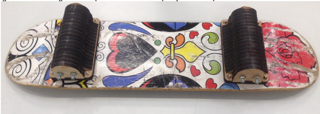
Figura 54 – Montagem do suporte/sistema de aquisição no shape.
