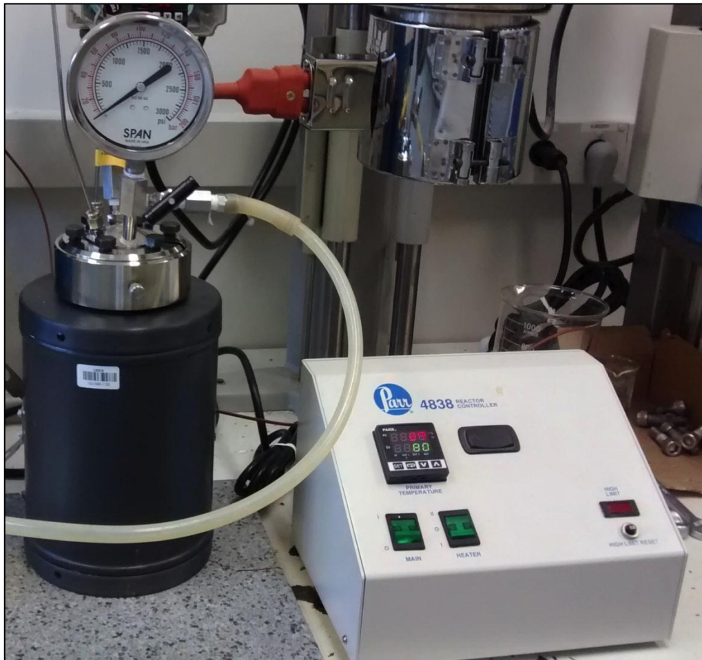
Figura 6.2. Reator da marca Parr utilizado para realização dos ensaios de indução à corrosão. Fonte: o autor.
