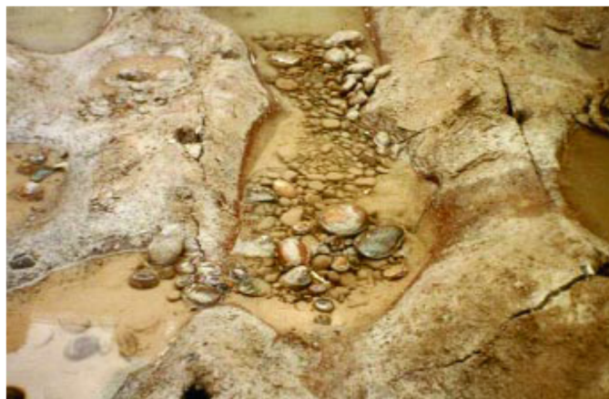
Figura 3.3 - Abrasão de detritos na água corrente. Credito da imagem: Portland Cement Association (PCA), 2002.
