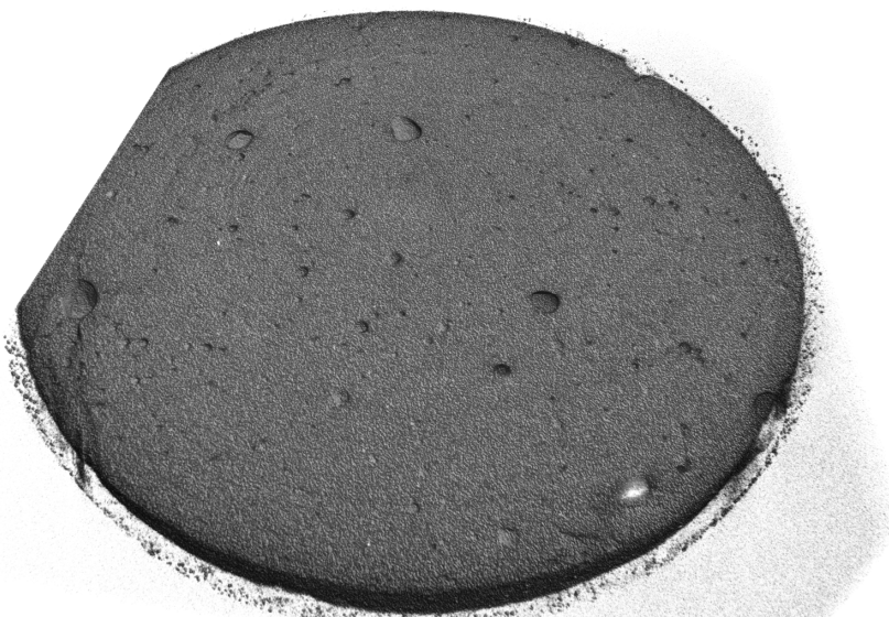
Figura 5.15- Corte transversal, no corpo de prova imerso em solução de ácido nítrico por 86 dias, mostrando na matriz cimentícia microfissuras, bolhas de ar (vazios) não sendo possível visualizar diferença de densidade em sua superfície e nas microfissuras. Crédito de imagem: Autora.
