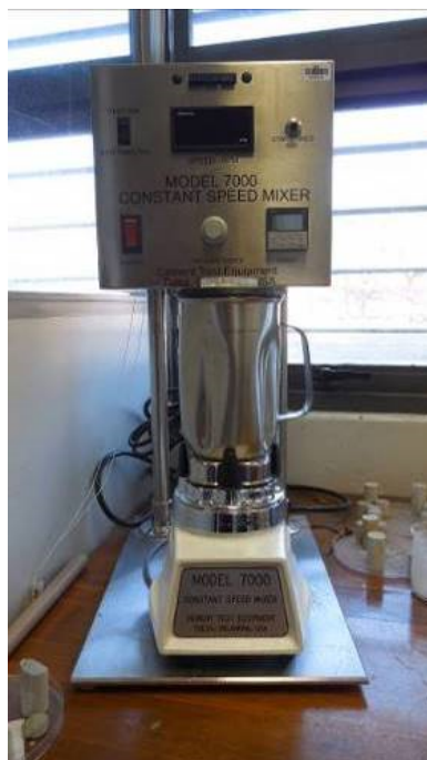
Figura 4.2 - Misturador utilizado na confecção dos corpos de prova. Crédito da imagem: Autora.
