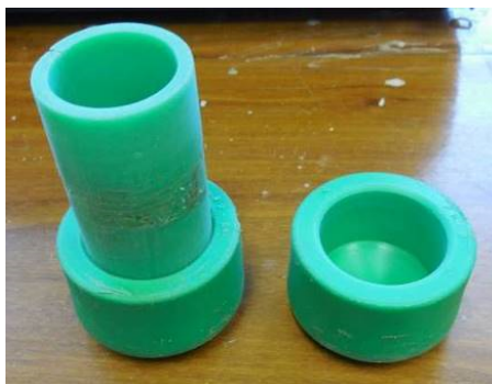
Figura 4.3- Molde utilizado na confecção dos corpos de prova. Crédito da imagem: Autora.
