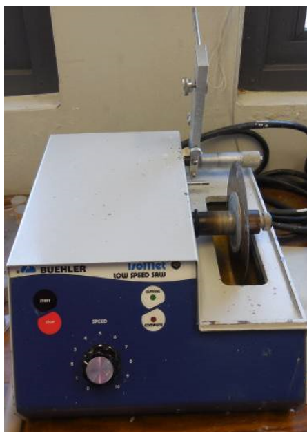
Figura 4.7 - Serra diamantada utilizada para cortar os corpos de prova. Crédito da imagem: Autora
