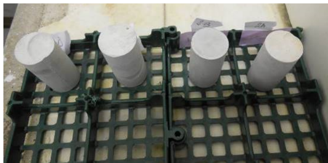
Figura 4.5 - Grade utilizada para secar os corpos de prova após a imersão em solução ácida. Crédito da imagem: Autora.
