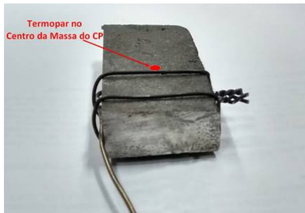
Figura 4.4 - Corpo de prova instrumentado para análise térmica.
