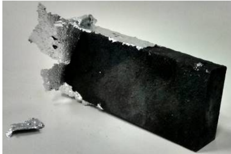
Figura 5.3 - Material sendo removido da superfície do corpo de prova.
