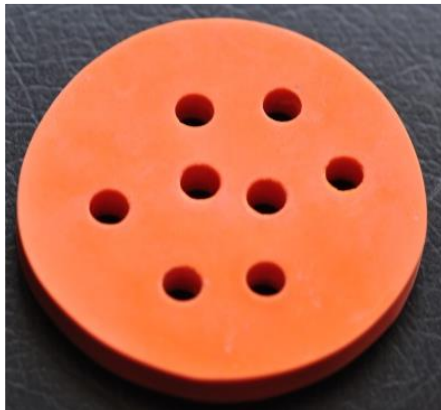
Figuras 1A e 1B. Dispositivo de silicone utilizado para confecção das amostras em resina composta e amostras confeccionadas prontas para escovação.
