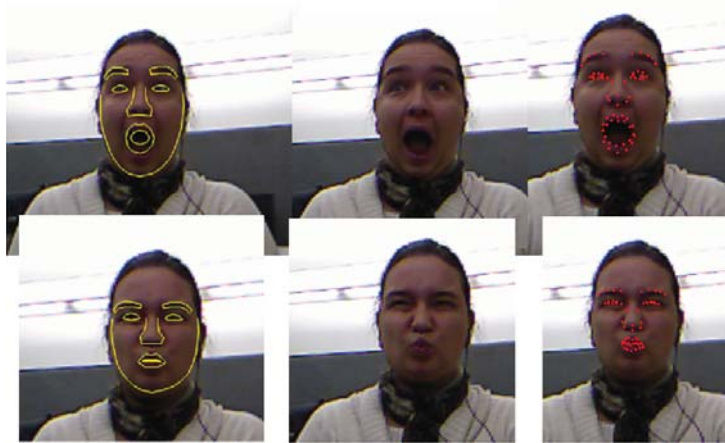
Figura 3.5: À esquerda, pontos característicos obtidos pelo rastreador de faces do Kinect . No centro, as imagem originais. À direita, resultado obtido utilizando-se o Live Driver .
