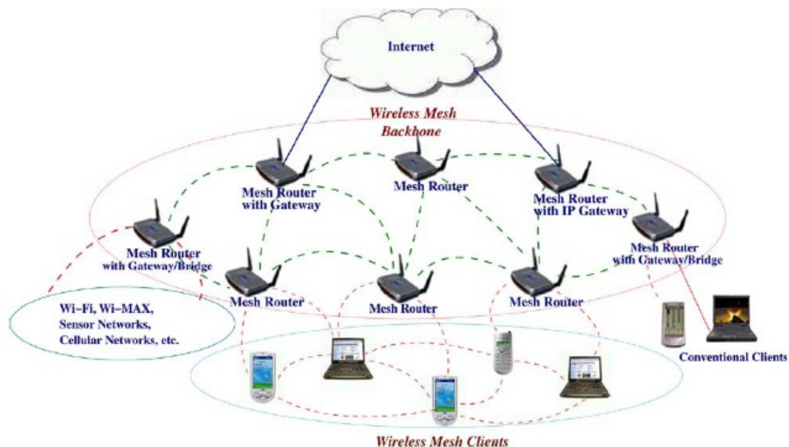
Figura 5.5: Exemplo de arquitetura mesh híbrida.
