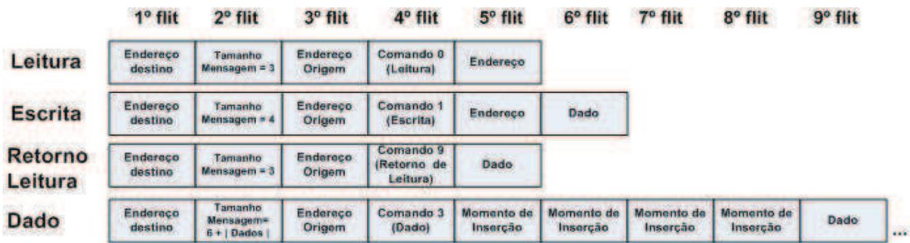
Figura 26 – Os quatro formatos de pacotes que circulam no interior da HardNoC-TB.
