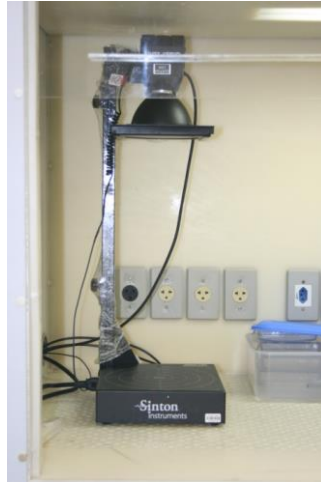
Figura 19 - Equipamento WCT-120 utilizado para medição do tempo de vida dos portadores de carga minoritários.
