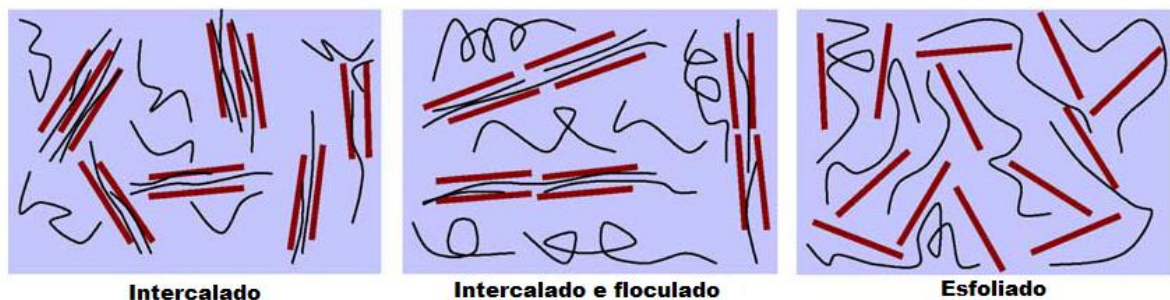
Figura 3.4. Representação esquemática dos diferentes graus de dispersão dos compósitos obtidos com silicatos lamelares (adaptado de Sinha Ray e Okamoto, 2003).
