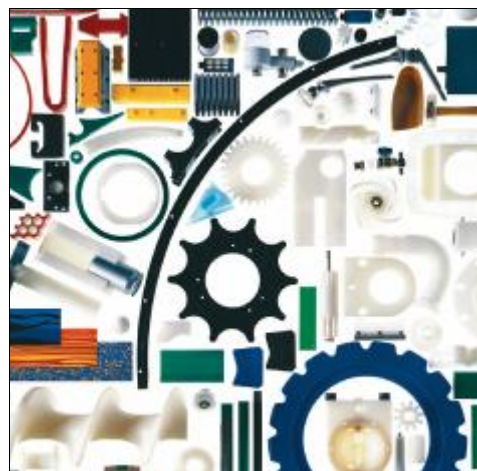
Figura 3.16. Exemplos de processamento por usinagem produzindo peças de PEUAPM de formas altamente complexas e muito bem dimensionadas
