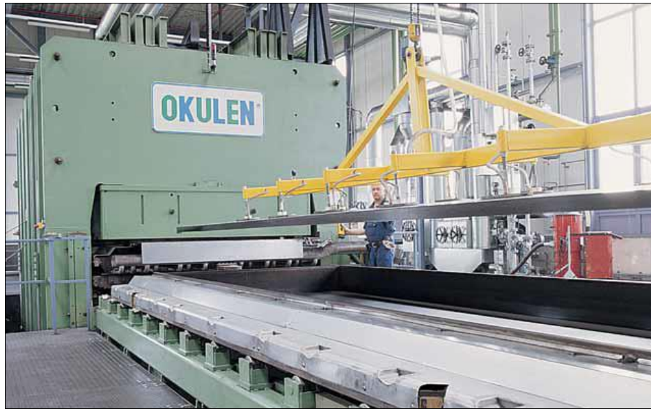
Figura 3.15. Moldagem por Compressão de PEUAPM: Prensa capaz de produzir componentes semi-acabados com espessura de 6 a 400 mm
