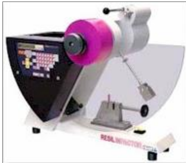
Figura 4.5. Equipamento CEAST modelo Resil 5.5 para análise de Impacto Charpy Fonte: CEAST (2013)
