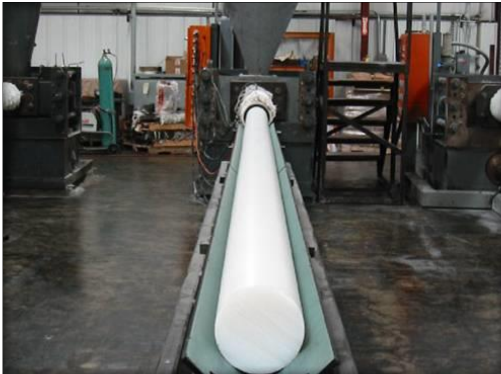
Figura 3.17. Na extrusora RAM, o PEUAPM compactado é submetido à sinterização, saindo finalmente do molde na forma contínua
