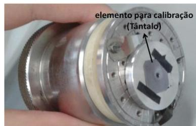
Figura 4. Lâmina de Tântalo colocada junto à entrada do capilar para realizar calibração do detector em termos de energia
