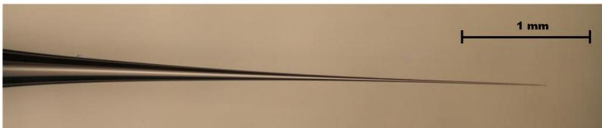
Figura 5. Imagens de microscopia ótica do Capilar 12, com diâmetro da ponta de aproximadamente  $6 \mu\text{m}$ .
