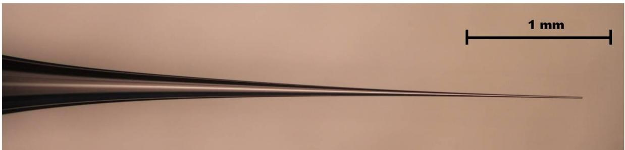
Figura 5. Imagem de microscopia ótica do Capilar 8, com diâmetro da ponta de aproximadamente  $7 \mu\text{m}$ .
