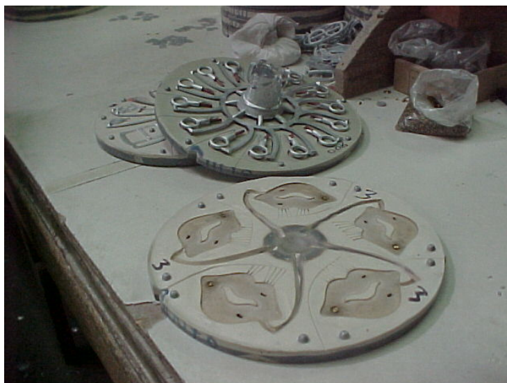
Figura 12: Demonstração de peças (ainda ligadas aos canais de alimentação) obtidas pelo processo de fundição por centrifugação [www.francanametall.com.br].
