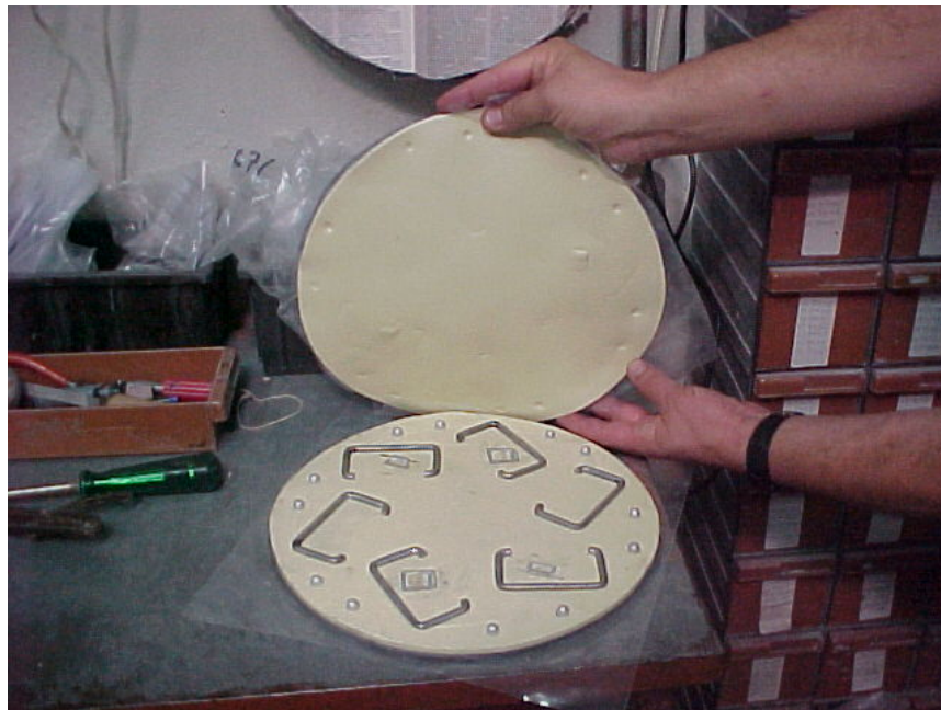
Figura 11: Demonstração do molde de borracha utilizado para a fabricação de jóias folhadas pelo processo de fundição por centrifugação [www.francanametal.com.br].
