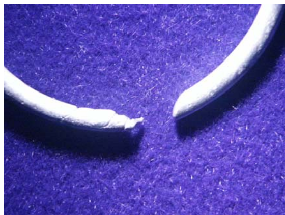
Figura 26: Exemplo de defeito em uma jóia folhada confeccionada com a liga a base de Zn-Al-Cu-Mg, relacionado com a falta de preenchimento do molde.
