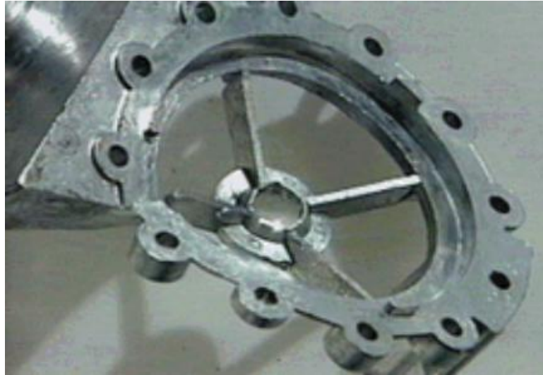
Figura 10: Exemplo de Problema de Empenamento em uma peça produzida por fundição sob pressão [CD DeZign, IZA].
