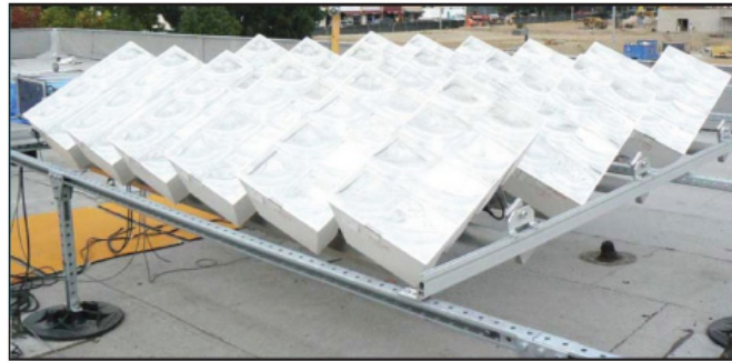
Figura 2.8. Arranjo de um sistema fotovoltaico, com 18 módulos fotovoltaicos concentradores, desenvolvidos pela Soliant Energy [17].
