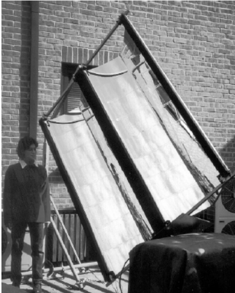
Figura 2.11. Módulo fotovoltaico concentrador com espelhos simples com seguimento do Sol com um eixo e concentração geométrica de 30 [18].
