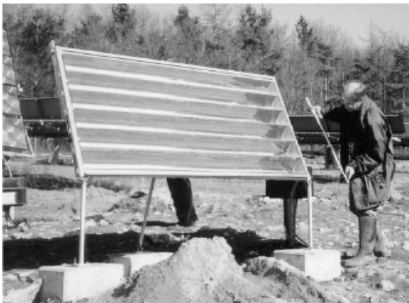
Figura 2.12. Módulo fotovoltaico concentrador com múltiplos espelhos em formato parabólico, sistema de seguimento manual e concentração geométrica de 6 [18].
