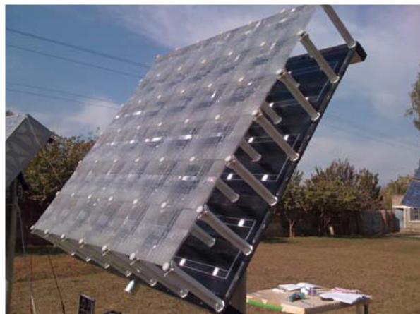
Figura 2.7. Módulo fotovoltaico concentrador, com concentração geométrica de 120, desenvolvido na Espanha [16].
