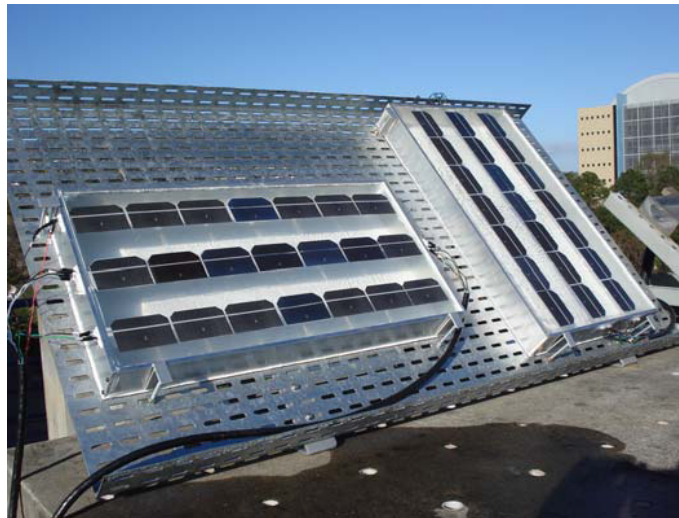
Figura 2.39. Esquema da colocação dos protótipos no Laboratório de Medidas Externas do NT-Solar [3].
