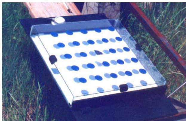
Figura 2.33. Primeiro protótipo, com células bifaciais circulares, do módulo concentrador estático plano (MEC-P) [1].
