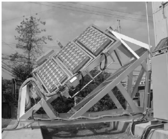
Figura 2.5. Módulo fotovoltaico concentrador desenvolvido no Japão, sua estrutura e o sistema de seguimento do movimento aparente Sol [15].
