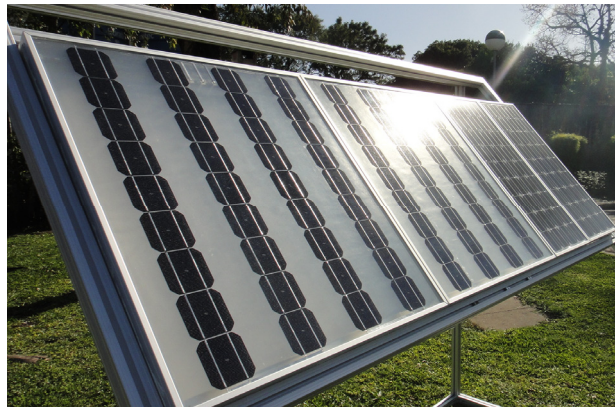
Figura 3.8. Módulos fotovoltaicos MEC-P. À direita, foram colocados dois módulos convencionais com o mesmo número de células solares e mesmo tipo de vidro.
