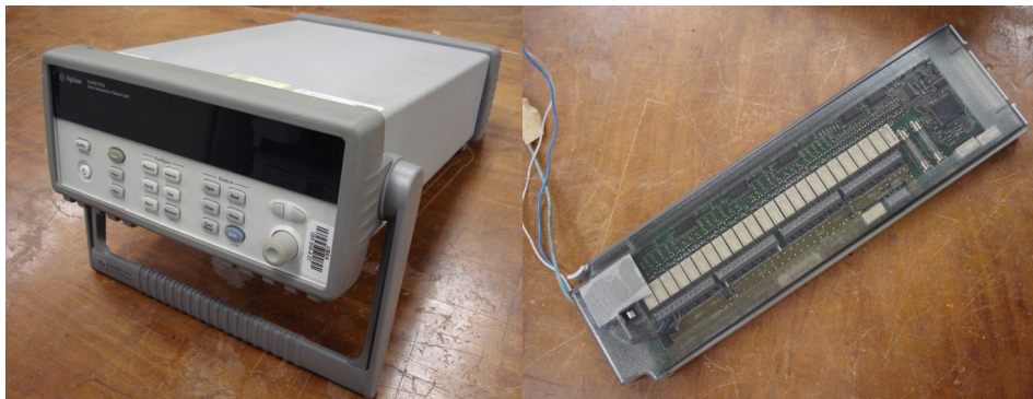
Figura 4.4. Multímetro e a placa multiplexadora para o sistema de aquisição de dados.
