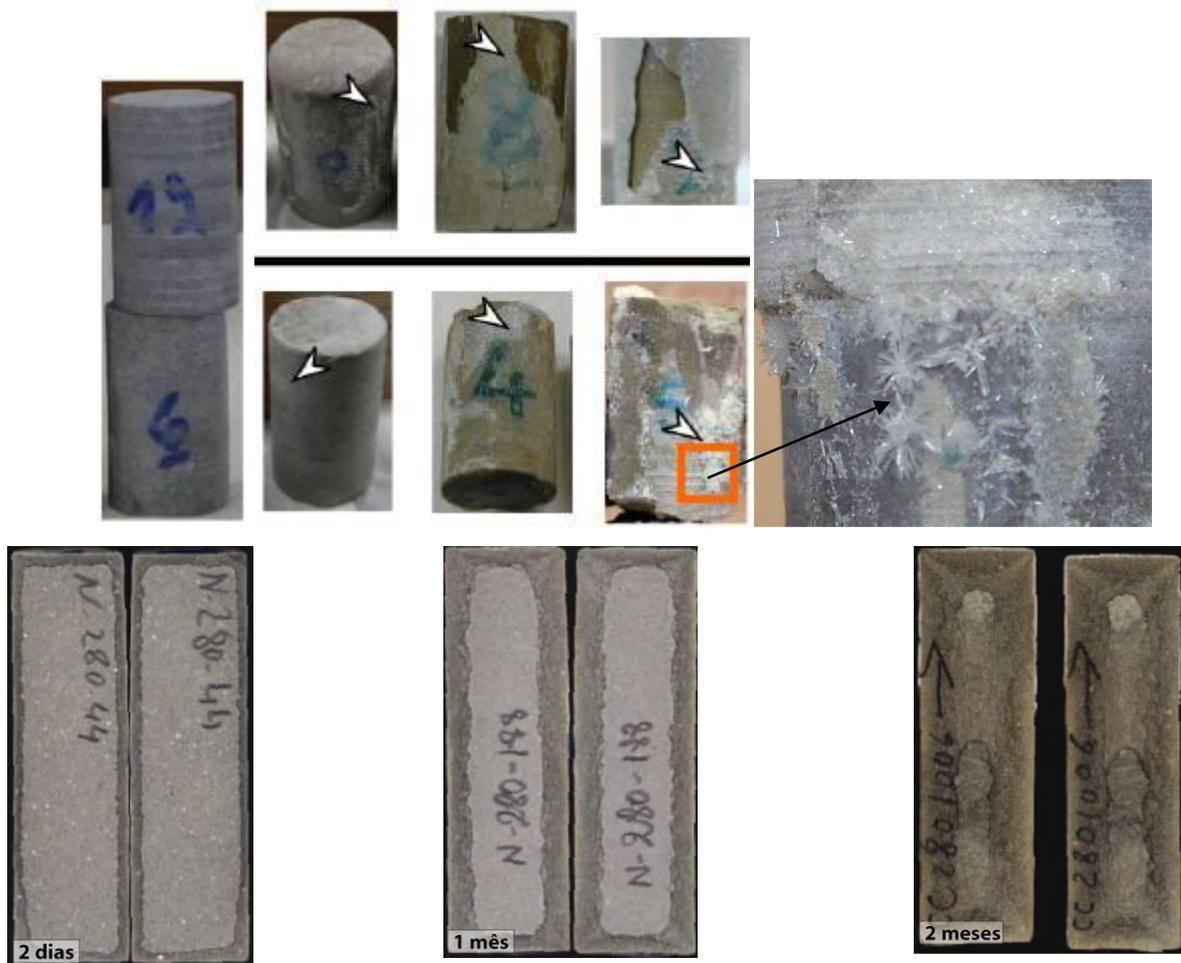
Figura 3.21: Amostras de pasta de cimento hidratadas degradadas por CO<sub>2</sub>. (Adaptado de Barlet-Gouédard *et al.* 2006).
