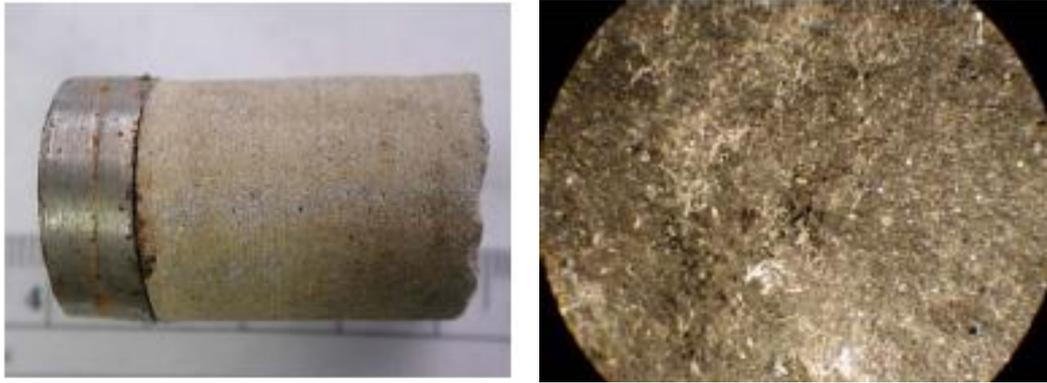
Figura 3.29: Testemunhos de aço e de cimento de um poço de 30 anos do campo produtor de CO<sub>2</sub> natural na formação de Dakota- EUA (Crow *et al.*, 2009). A região do cimento em contato com a formação/CO<sub>2</sub> apresentou uma camada de aproximadamente 4 mm de cristais de carbonato de cálcio precipitados.
