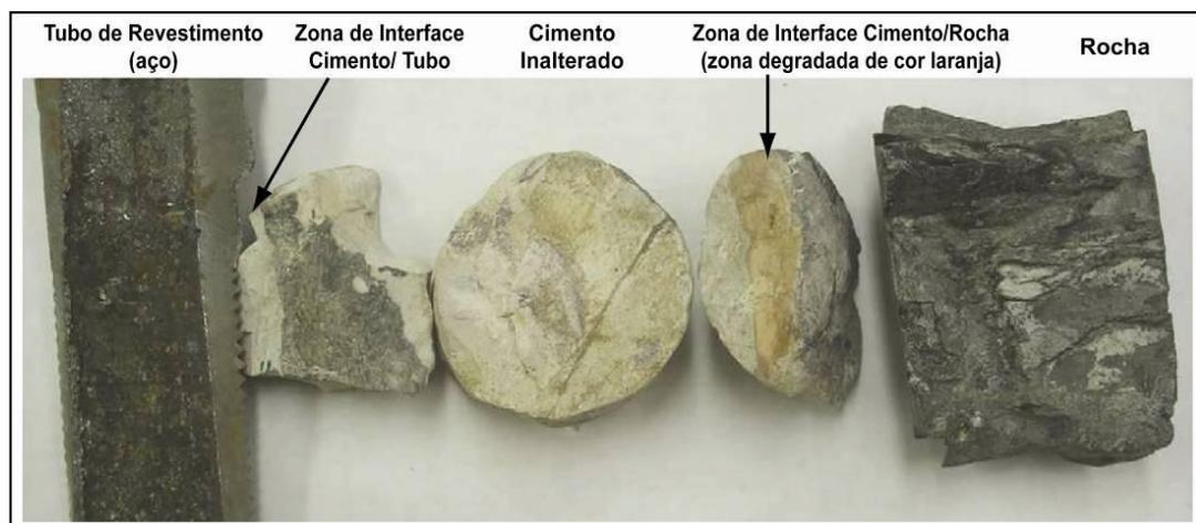
Figura 3.28: Testemunhos de aço, cimento e rocha do campo de SACROC no Texas - EUA. (Adaptado de Carey *et al.* 2007).
