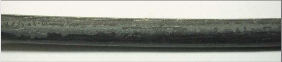
Figura 4.3. Amostra de fio máquina lubrificado na situação ideal, fio máquina seco. Camada de lubrificante de trefilação aderida: 1,33 g/m 2 .
