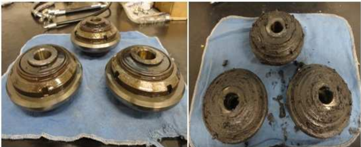
Figura 4.5. (a) Trio de cassetes de laminação montados e, em (b) cassetes repletos de lubrificantes, após a utilização com fio-máquina úmido.
