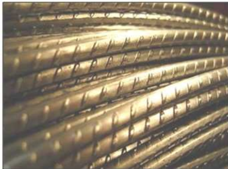
Figura 3.7. Vergalhão produzido a partir do fio máquina, com saliências (nervuras) produzidas por laminação a frio com o trio de cassetes da figura.
