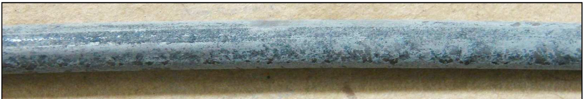
Figura 4.4. Amostra de fio máquina lubrificado na situação não ideal, fio máquina molhado. Camada de lubrificante de trefilação aderida: 3,67 g/m 2 .
