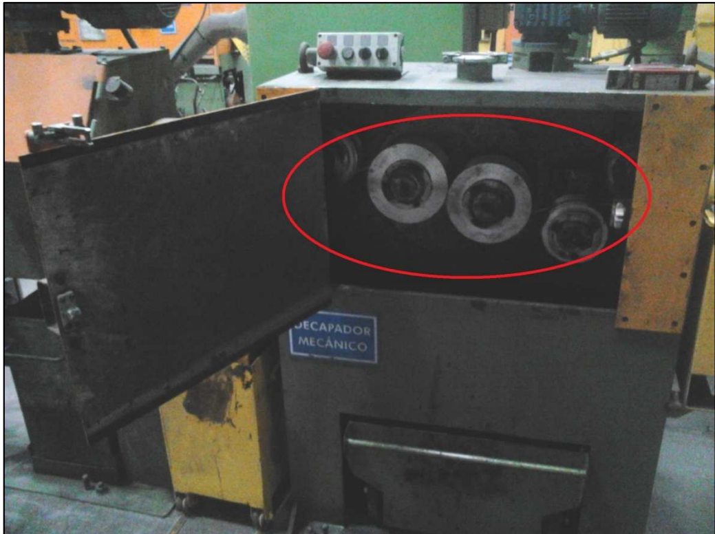
Figura 3.11. Decapador mecânico com detalhe nos rolos flexionadores.
