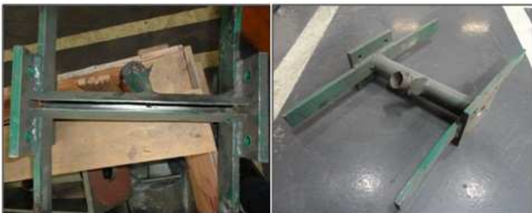
Figura 5.3. Detalhe do tubo de aço onde foram fixados os bicos sopradores e os mancais (Obs.: bico soprador á 45°).
