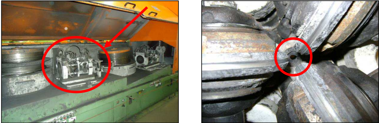
Figura 3.6. (a) Cassetes laminadores montados na máquina. (b) Detalhe da disposição dos discos de metal duro a 120° e do orifício onde o fio máquina passa.
