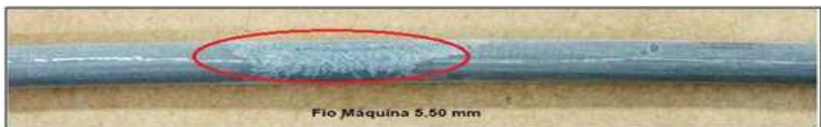
Figura 5.6. Amostra de fio máquina do primeiro dispositivo testado, sistema B, apresentando parte da camada expandida.
