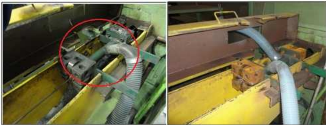
Figura 5.2. a) Instalação do sistema B na laminadora. B) instalação do sistema A com dois dutos.
