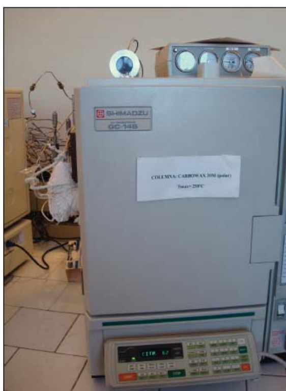
Figura 4.4. Cromatógrafo CG/FID/O utilizado na análise dos óleos essenciais obtidos por destilação por arraste a vapor.
