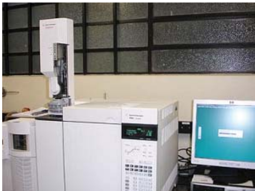
Figura 4.3. Equipamento de cromatografia gasosa acoplado à espectrometria de massas (CG/MS) que foi utilizado nas análises dos óleos essenciais obtidos por destilação por arraste a vapor.
