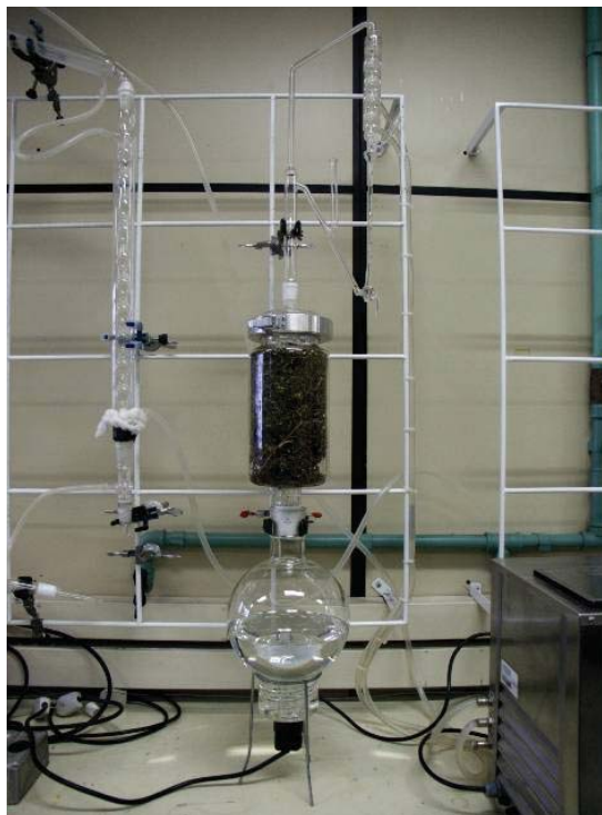
Figura 4.2. Unidade laboratorial de destilação por arraste a vapor utilizada para extração dos óleos essenciais das espécies de Baccharis .
