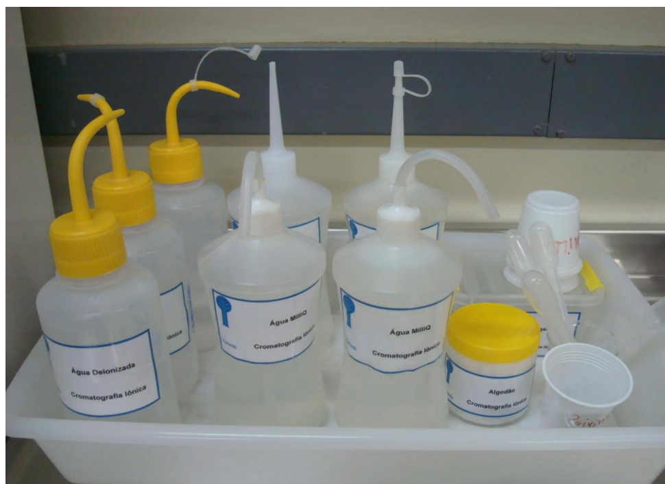
Figura 5.11 LQAmb depois do Programa 5S Materiais com Padronização na Identificação
