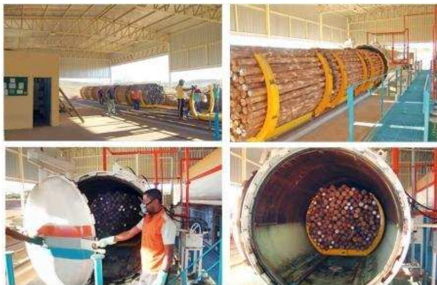
Figura 3.10. Processo de tratamento de postes de eucalipto em autoclave.
