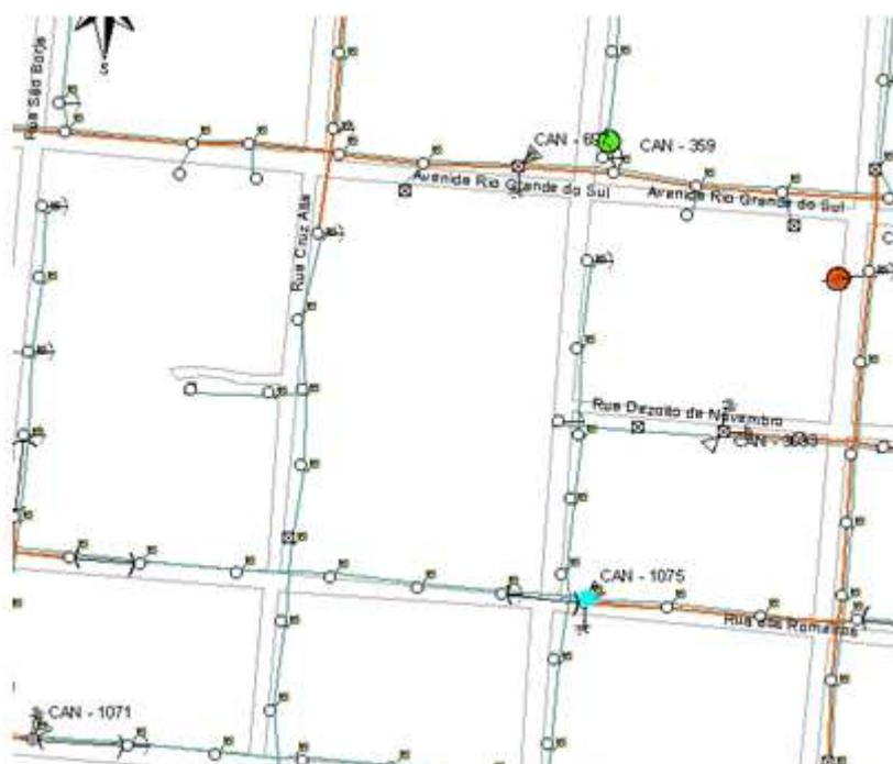
Figura 4.6. Esquema da rede elétrica da AES Sul, bairro Mathias Velho, circuito CAN - 1075
