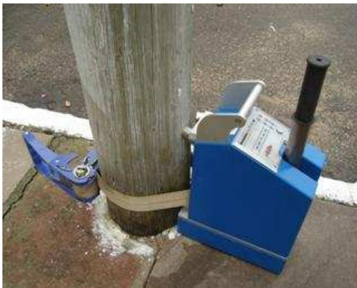
Figura3.25.Polux ® testando poste de madeira *in situ*
