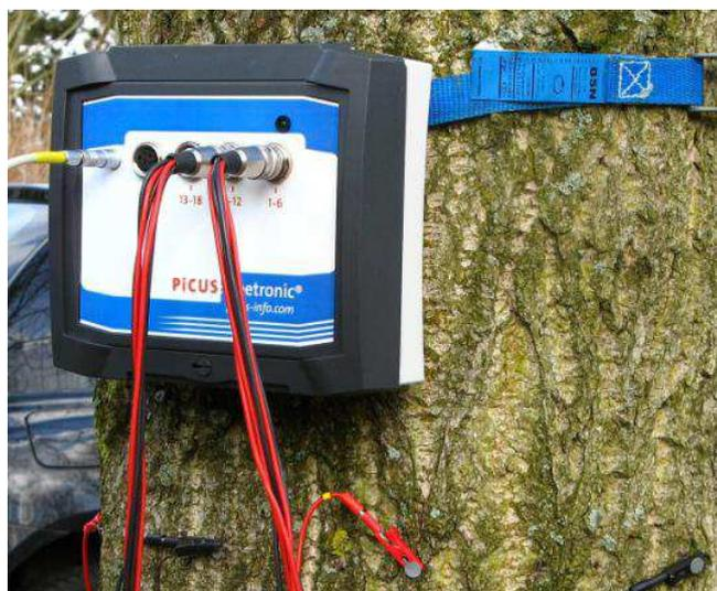
Figura3.21. Tomógrafo de Impedância Elétrica – PICUS®
