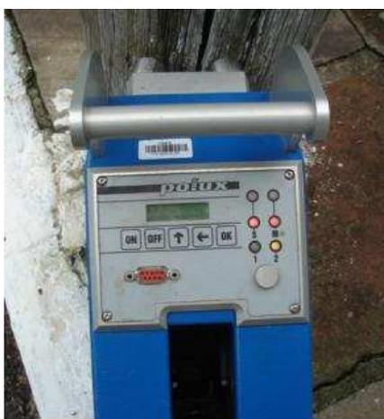
Figura 3.26. Painel Frontal do Polux®, com a indicação dos aspectos de segurança e manutenção
