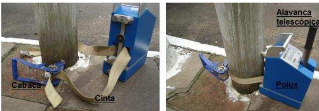
Figura 4.10. Fixação do equipamento no poste de madeira
