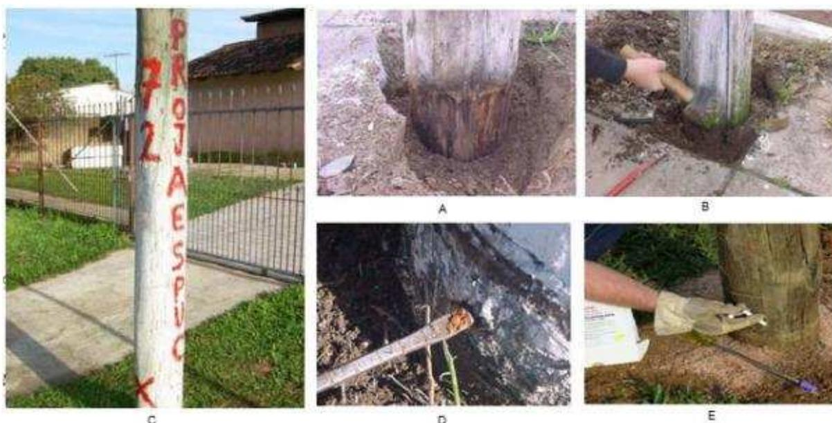
Figura 4.7. Etapas: (A) Verificação do apodrecimento externo; (B): Análise da parte interna através de percussão; (C): Identificação dos postes para coleta; (D) Verificação do apodrecimento interno; (E): Retratamento
