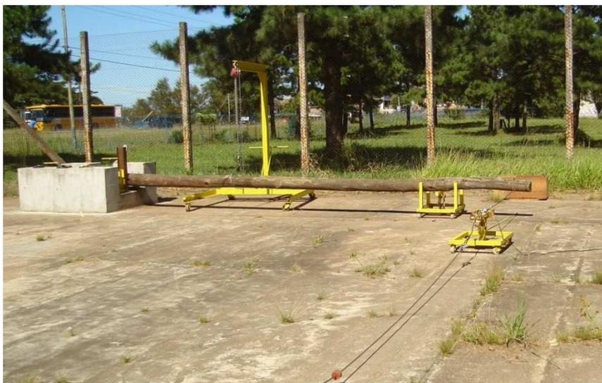
Figura3.18. Campo de testes dos ensaios de resistência à flexão dos postes de madeira em Viamão/RS.
