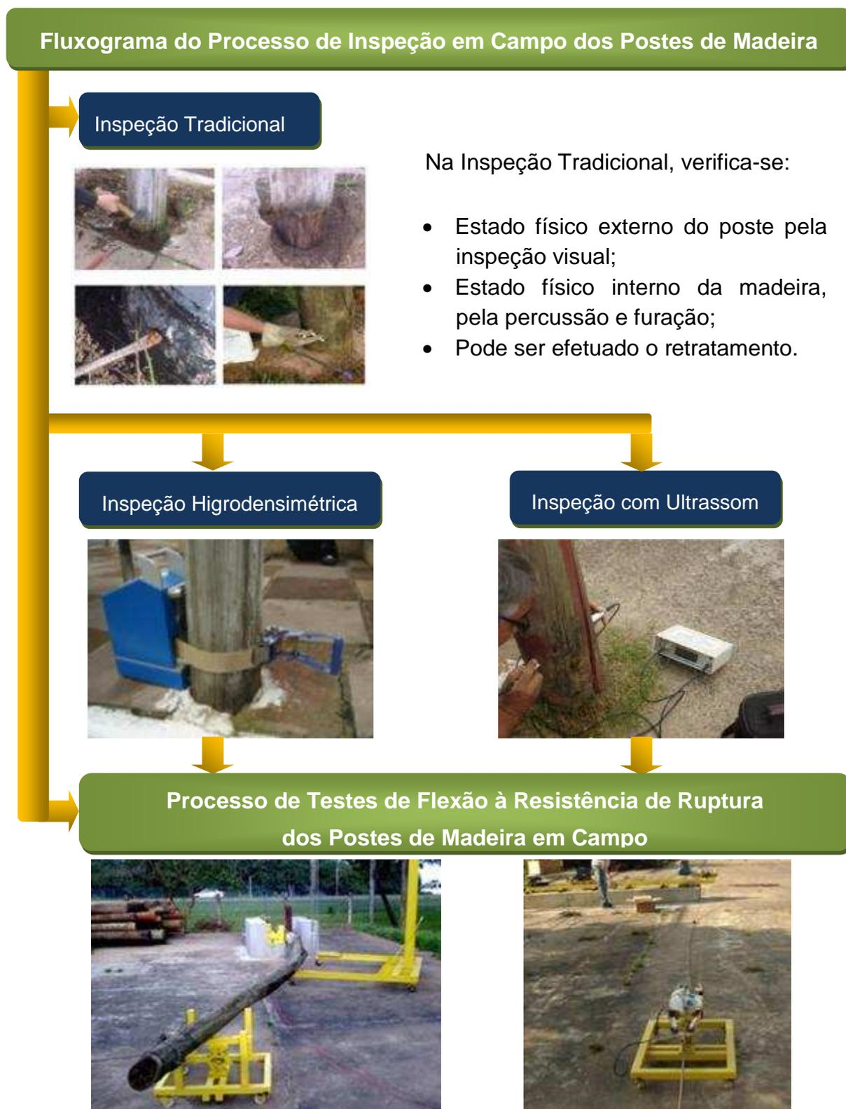
Figura 4.4. Fluxograma do processo de inspeção e teste de flexão à resistência de ruptura
