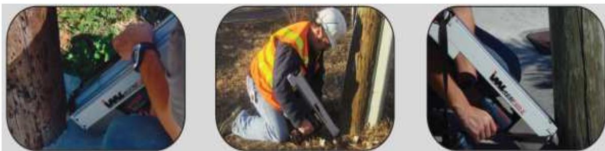
Figura 3.23. Utilização do resistógrafo em poste de madeira
