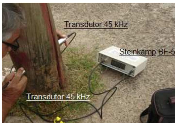
Figura 4.15. Medição com ultrassom em poste de madeira
