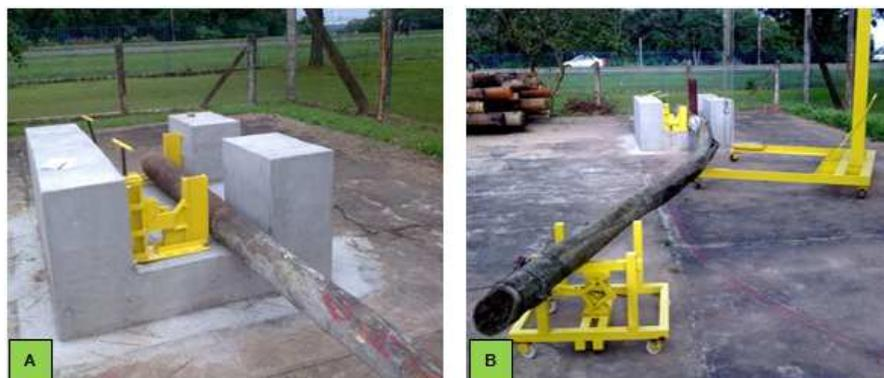
Figura 4.17. (A) e (B) – Teste de flexão de poste retirado da rede
