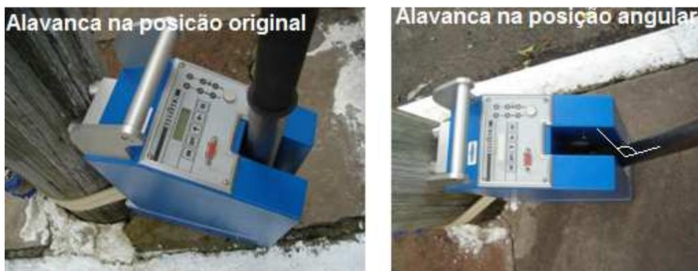
Figura 4.12. Polux ® em medição de poste de madeira
