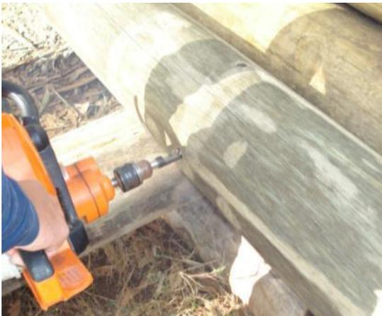
Figura 4.13 Coleta de amostra de madeira.
