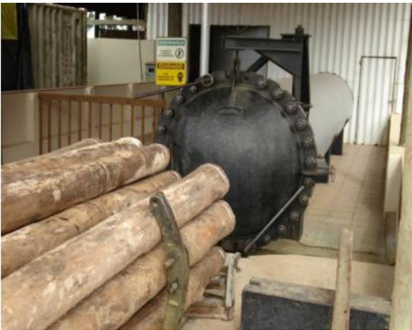
Figura 4.9 Tratamento dos postes em autoclave.
