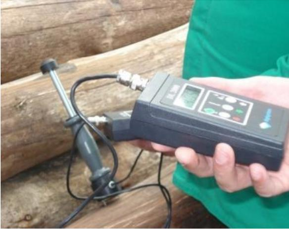
Figura 4.7 Controle de umidade em postes.
