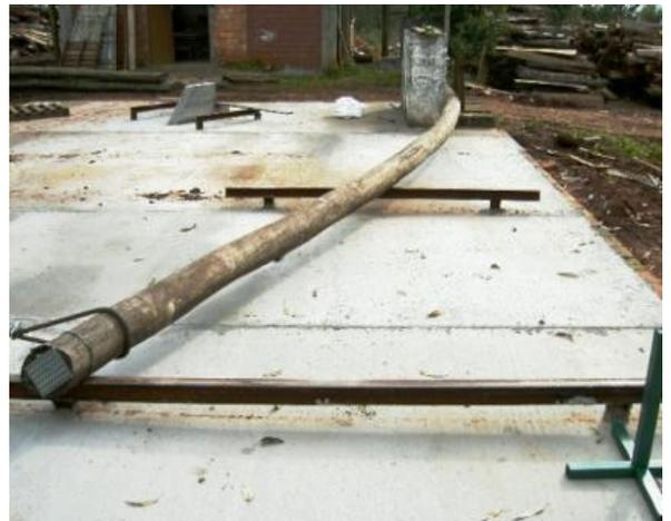
Figura 4.10 Poste sendo flexionado para avaliação de resistência mecânica.
