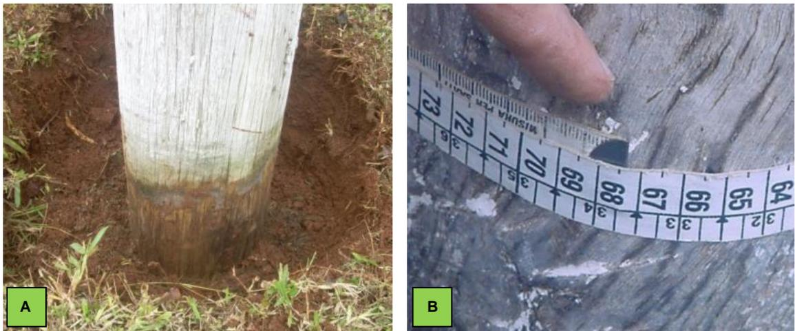
Figura 4.18 (A e B). Escavação na base do poste e medição dos diâmetros 1 e 2.
