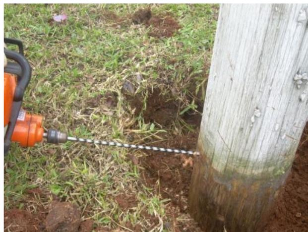
Figura 4.19 Perfuração para inspeção interna.
