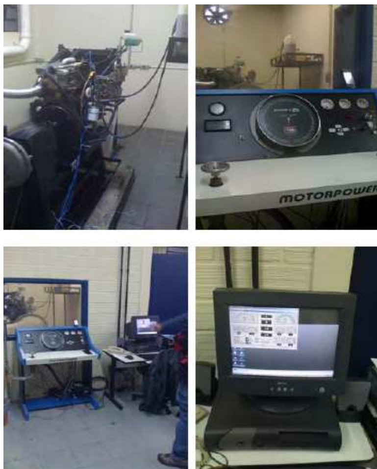
Figura 4.12. Fotos do motor instalado no dinamômetro e detalhes dos mostradores do equipamento e do software de controle e monitoramento [Ruschel, 2009].
