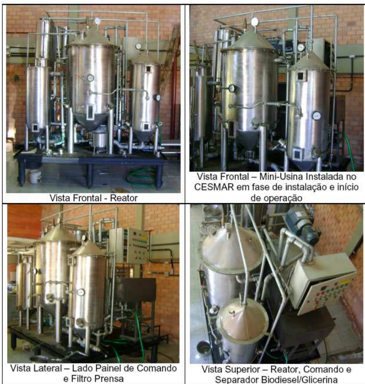
Figura 4.2. Vistas gerais da mini-usina piloto de biodiesel.
