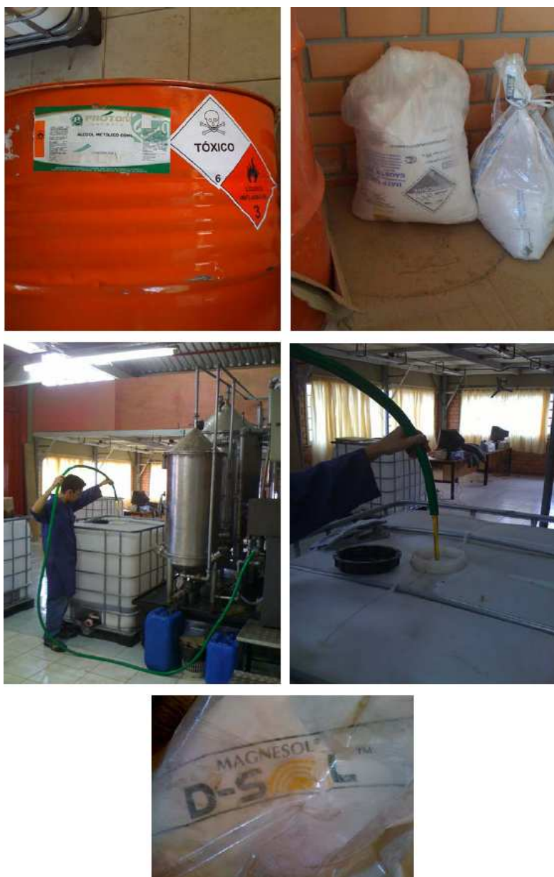
Figura 4.9. Reagentes utilizados: metanol, soda caustica, adsorvente e biodiesel produzido.
