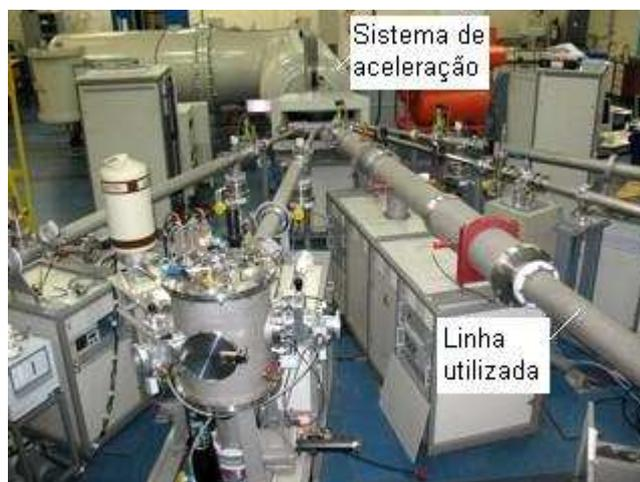
Figura 4.1. Fotografia do acelerador Tandatron de 3 MV do Laboratório de Implantação Iônica da UFRGS.
