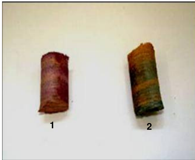
Figura 5.5. Aplicação de teste colorimétrico para identificar a presença de Cu em poste de madeira (novo) tratado com CCA. Corante 1: PAN e corante 2: cromo azurol S.
