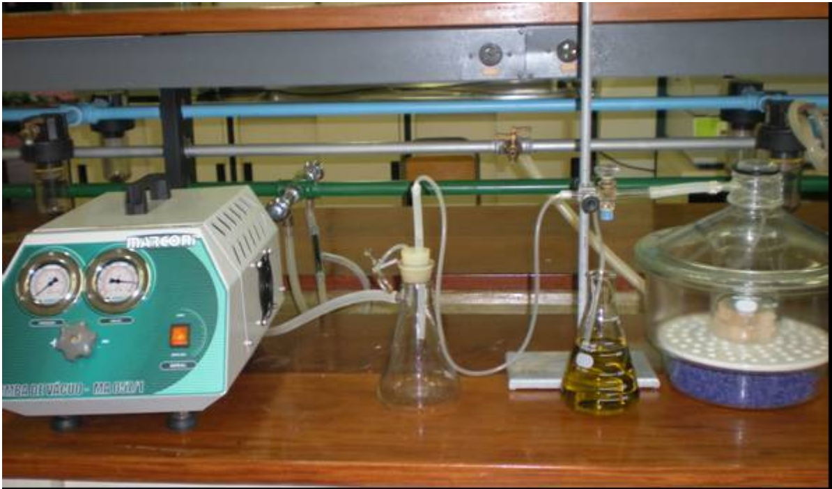
Figura 5.2. Sistema montado para impregnação dos blocos de madeira in natura segundo AWPA E10-08 (2008).
