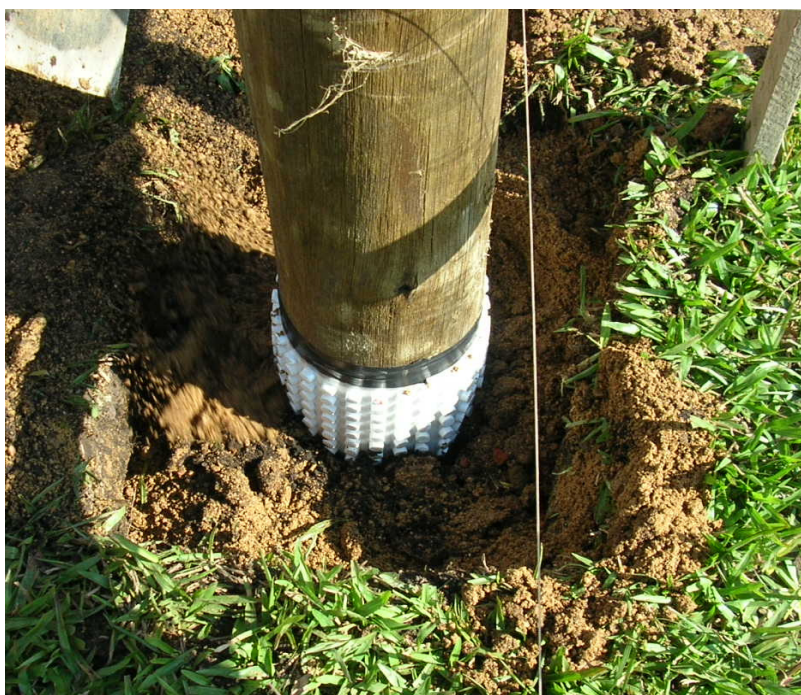
Figura I.1. Aplicação da bandagem Bioguard® em mourão da Área de Teste Controlada em Canoas/RS
