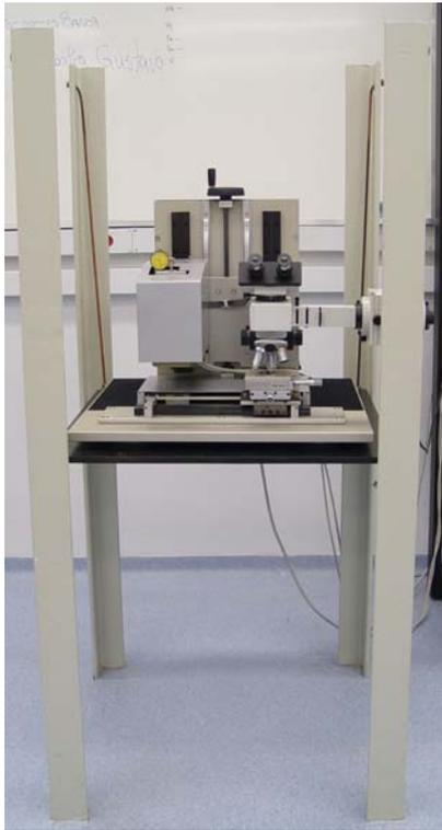
**Figura 26: Equipamento de nanodureza utilizado para as análises das propriedades mecânicas dos filmes finos de  $\text{TiO}_x$ .**
