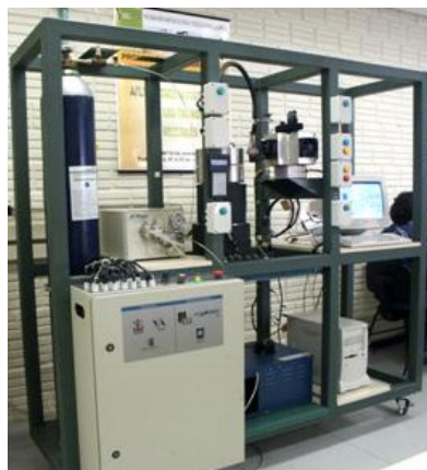
Figura 4.3 Unidade Piloto de Extração Supercrítica do LOPE (Fonte: autor)
