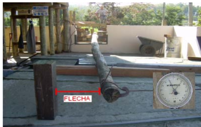
Figura 4.3. Ensaio em campo de testes com aproximação a ASTM D 1036 (1990), mostrando flecha vertical “x”.
