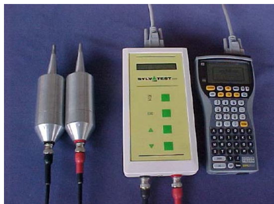
Figura 3.25. Equipamento de ultra - som (SYLVATEST).
