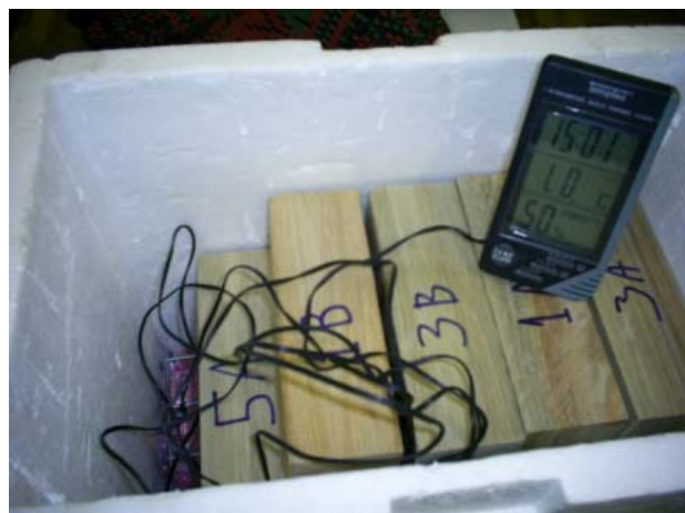
Figura 4.10. Amostras na caixa de acondicionamento com sílica-Gel.
