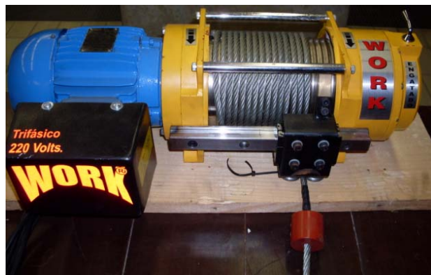
Figura 4.16. Guincho para tração do poste.
