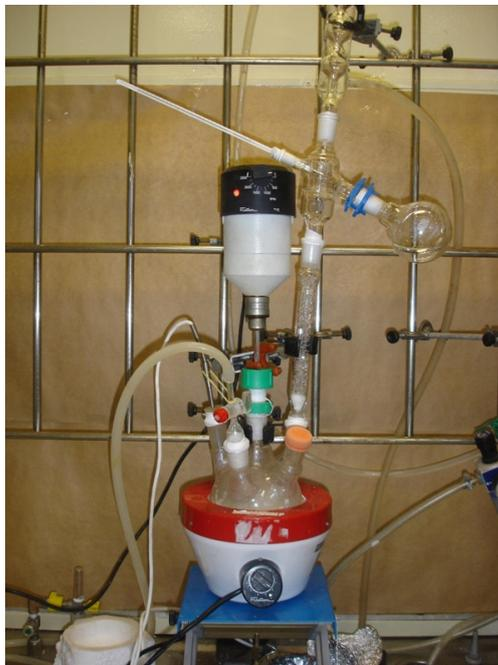
Figura 4.1 Reator utilizado na síntese do poliéster termoplástico
