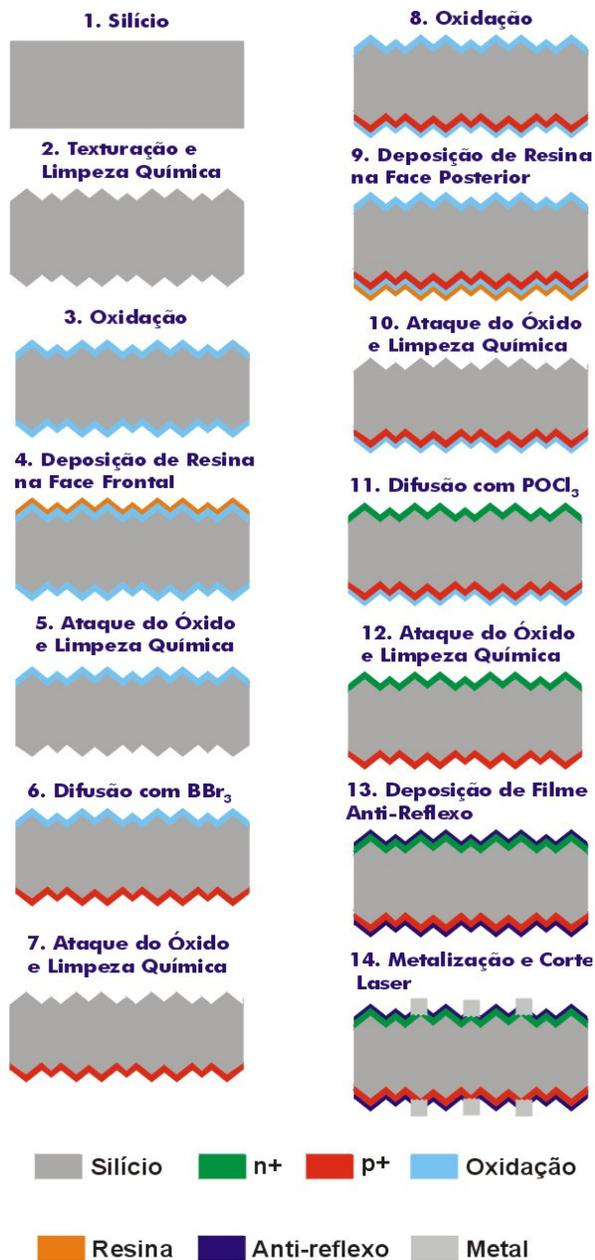
Figura 4.13. Esquema do processo de fabricação de células solares bifaciais com o dopante  $BBr_3$  para formar a região  $p^+$ .
