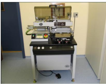
Figura 4.3 Equipamento utilizado para realização do processo de serigrafia.
