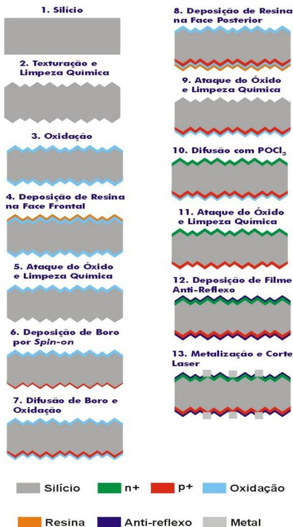
Figura 4.19. Esquema do processo de fabricação de células solares bifaciais industriais com formação da região  $p^+$  com o dopante PBF 20 e processo térmico de difusão de boro e oxidação em passo único.
