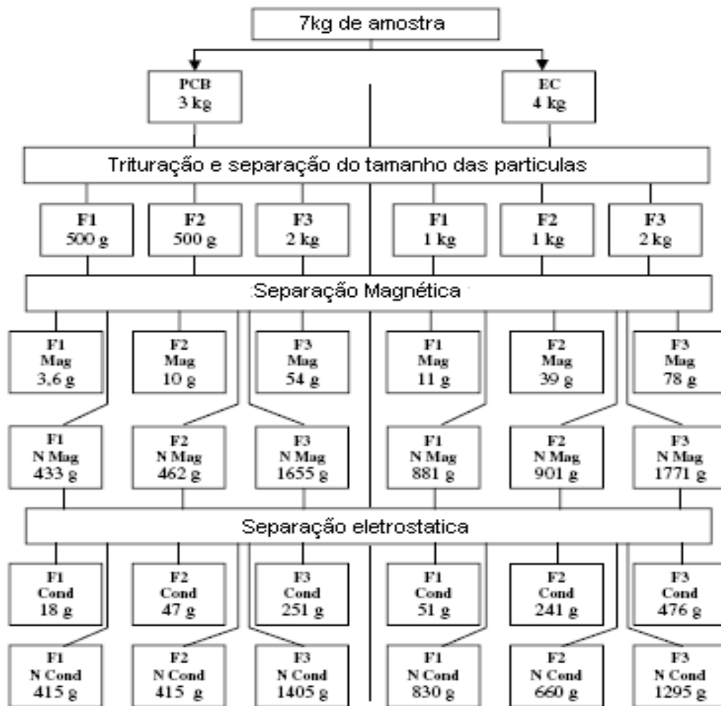
Figura 3.1 - Esquema de reciclagem de placas de circuito impresso. F1<0,25mm; 0,25<F2< 0,50mm; 0,50<F3<1,00mm. Mag: magnético; N Mag: não magnético; Cond: condutor; N Cond: não condutor; PCB: placa de circuito impresso; EC: componente eletrônico (Veit, 2005).
