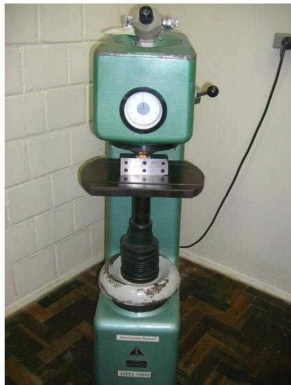
Figura 4.10. Durômetro para medição Brinell.
