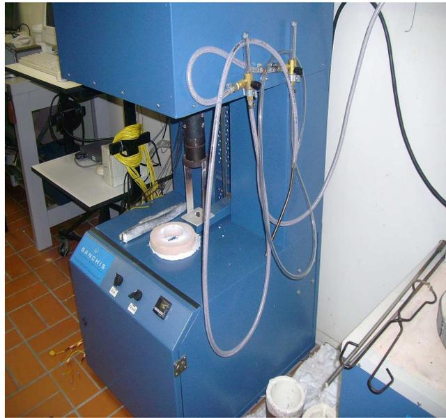
Figura 4.7. Detalhe da instalação dos rotômetros.
