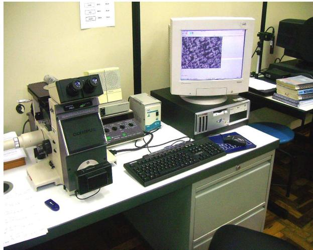
Figura 4.9. Microscópio óptico e sistema de tratamento de imagens.
