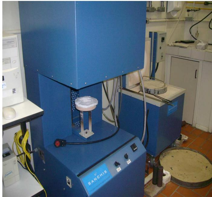
Figura 4.2. Foto externa do forno de fusão/solidificação unidirecional.
