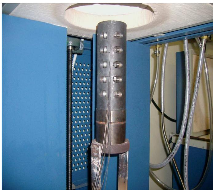
Figura 4.5. Lingoteira com os termopares instalados.
