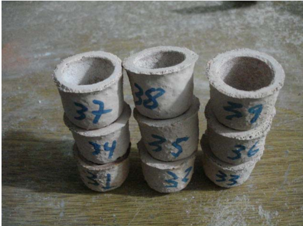
Figura 6.1- Fotografias dos moldes cerâmicos utilizados nos experimentos da-segunda etapa.
