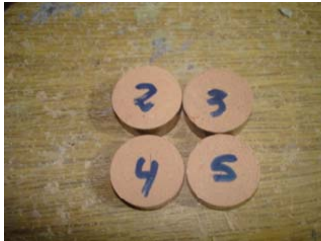
Figura 4.7- Amostras de pó cerâmico após ensaio de compressibilidade.
