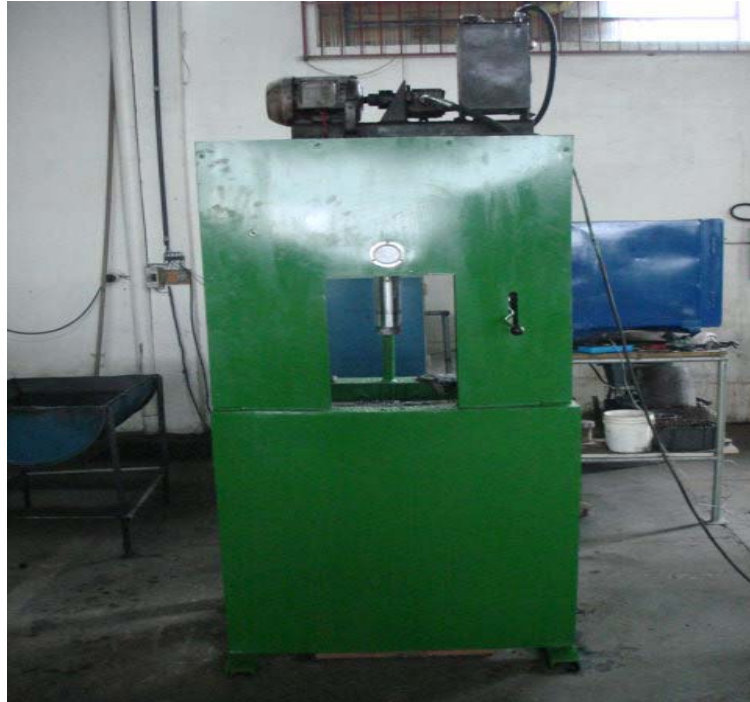
Figura 4.10- Prensa hidráulica utilizada para a compactação das amostras.
