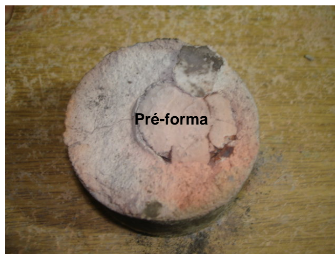
Figura 7.1- Vista inferior da amostra 36 deformada, circundada pelo meio secundário compressor, compactada a baixa pressão (~248 MPa).
