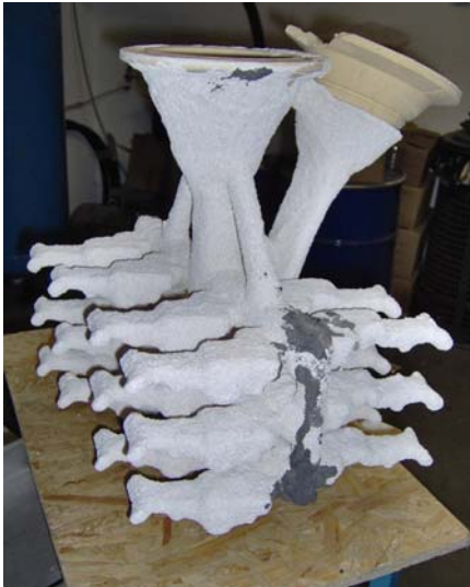
(c) Cachos revestidos com lama cerâmica
