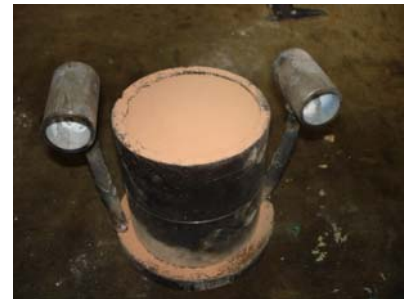
(e) Container com o molde e preenchido com pó cerâmico
