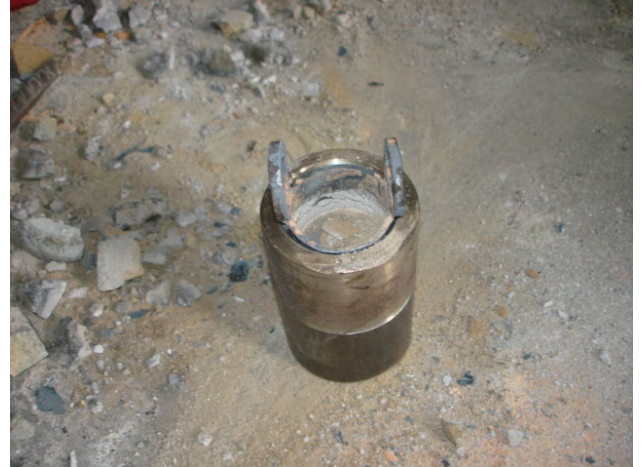
(b) Conjunto container com o pó cerâmico , molde cerâmico com o pó de ferro com tampa metálica
