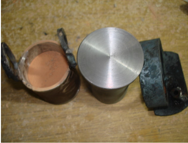
(a) Container com o pó cerâmico , punção e tampa metálica
