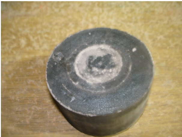
(c) Amostra já sinterizada e compactada, ainda no container e dentro da matriz de compactação.
