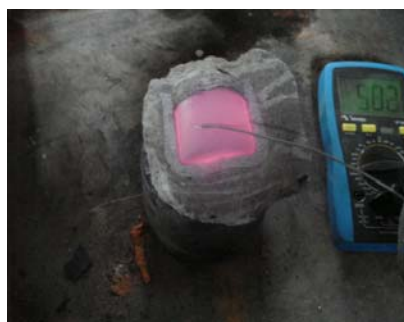
(k) Molde cerâmico e pré-forma ainda incandescente após extração
