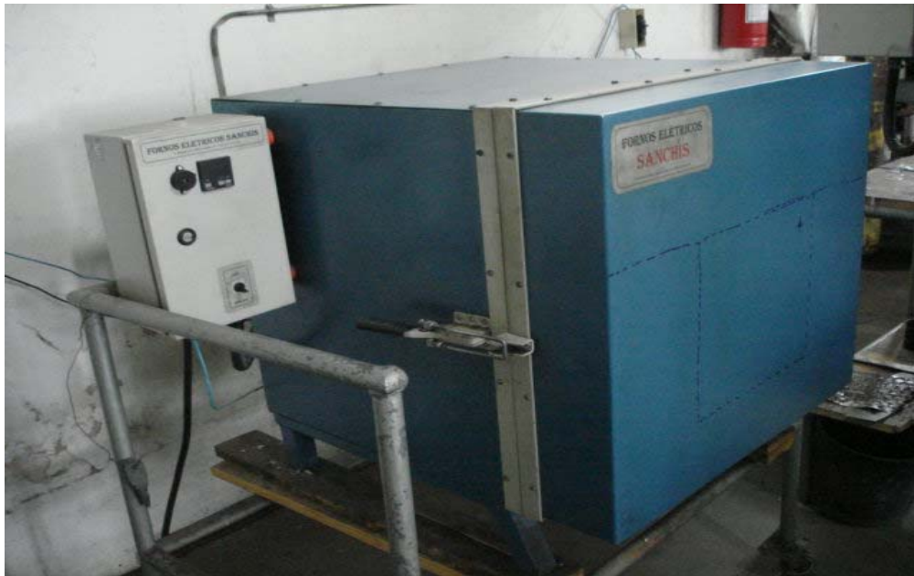
Figura 4.9- Forno resistivo utilizado para aquecimento do container com o meio compressor secundário com o molde cerâmico contendo o pó de ferro.
