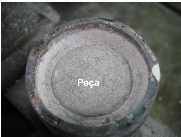
(e) Conjunto container-meio compressor secundário-peça pronto para ser desmoldado
