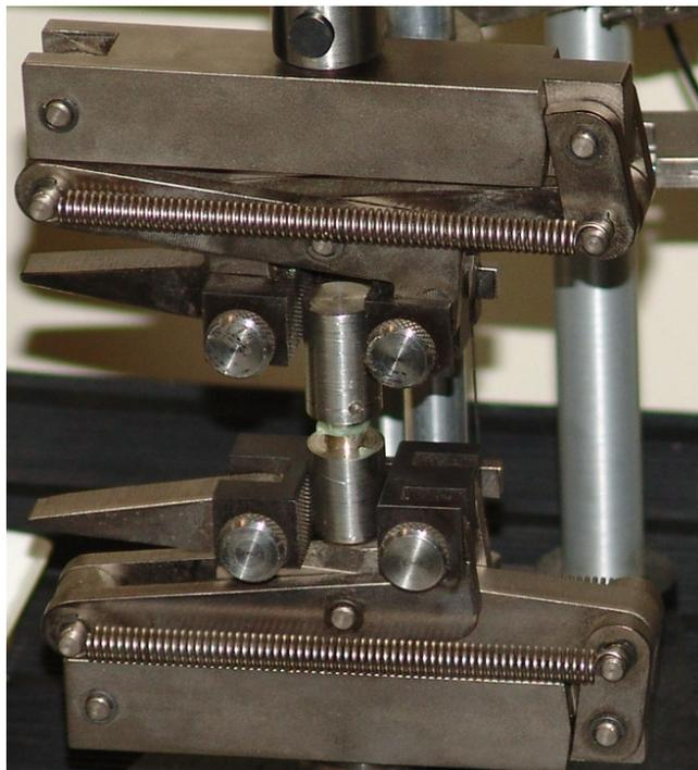
Figura 16: Equipamento de ensaio de tração com amostras.
