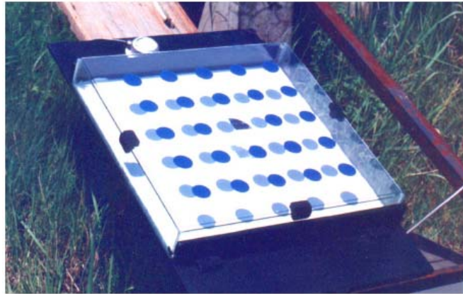
Figura 2.17. Primeiro protótipo, com células bifaciais circulares, do módulo concentrador estático plano [15].
