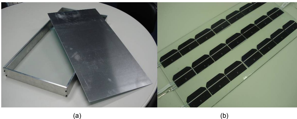
Figura 3.2. (a) Estrutura montada do protótipo com o vidro temperado e o refletor de alumínio não pintado e (b) células solares encapsuladas.
