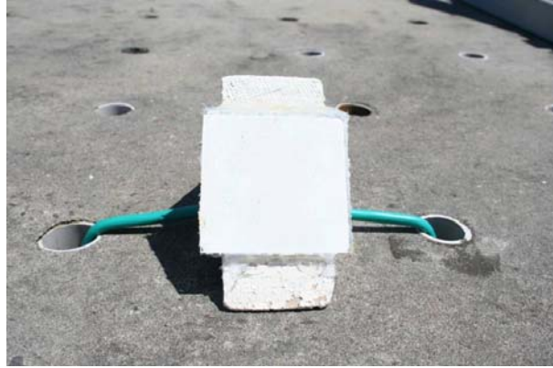
Figura 3.7. Amostra de alumínio pintado com tinta branca e encapsulada com EVA e vidro.
