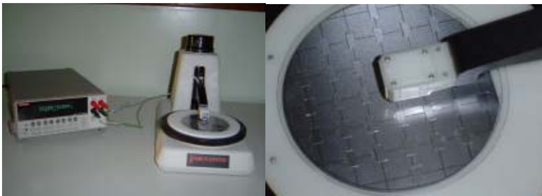
Figura 4.7. Equipamento “quatro pontas” utilizado para medição da resistência de folha.
