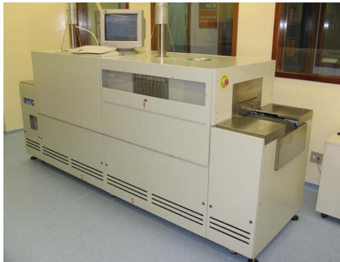
Figura 5.2. Forno de infravermelho para queima de pastas serigrafias instalados no Laboratório de Metais do NT-Solar.
