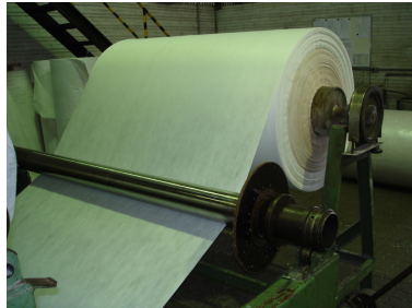
Figura 3.19 - Rolo de não-tecido na entrada da Rama .
