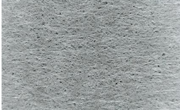
Figura 3.12 - Não-tecido agulhado de poliéster. Fonte: MORONI (2005, p.13)
