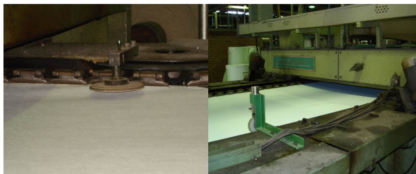
(a) (b) Figura 3.22 - (a) Morcetes prendendo a manta; (b) Entrada da manta no secador.
