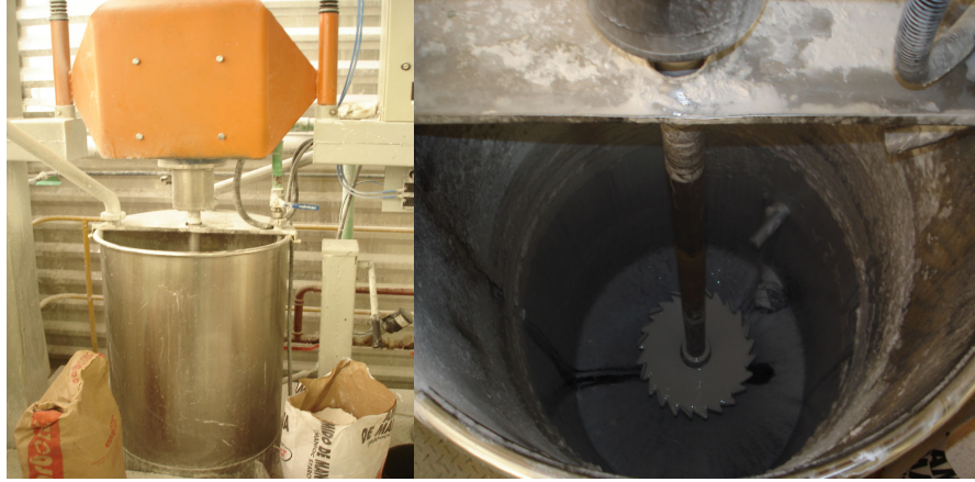
Figura 4.1 - Tanque de dispersão com agitador mecânico.
