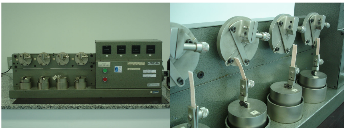
(a) (b) Figura 4.7 - (a) Máquina de flexão; (b) Corpos de prova rompidos.
