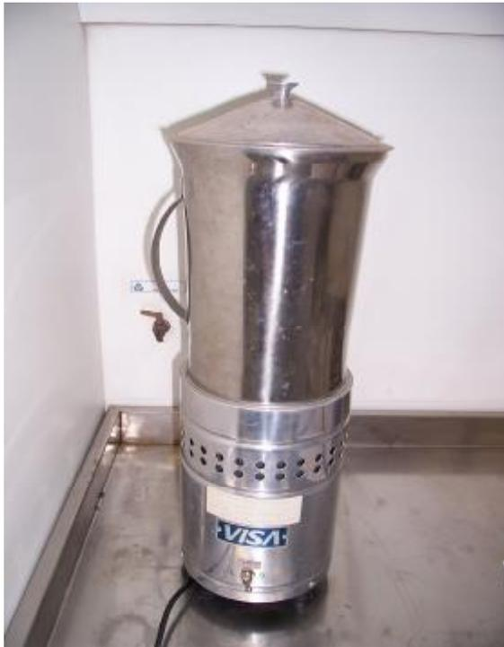
Figura 12 – Liquidificador industrial (marca Visa) utilizado na trituração do material para posterior peneiramento
