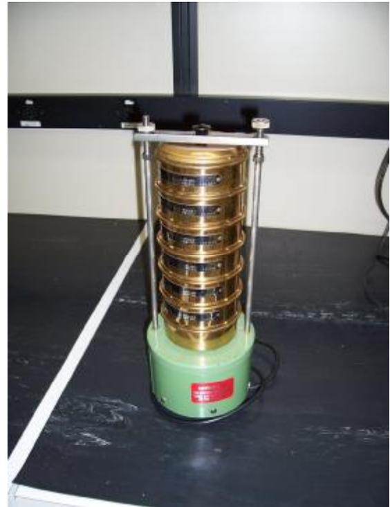
Figura 13 – Peneiras de cobre utilizadas na separação granulométrica do material triturado
