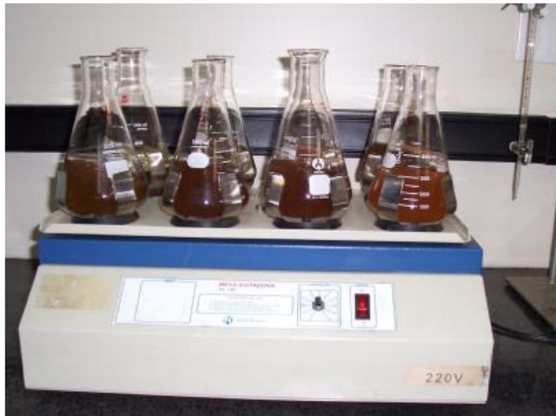
Figura 14 – Mesa agitadora (marca Nova Técnica) utilizada para os testes
