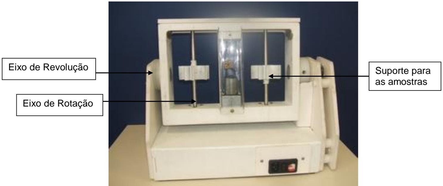
Figura 2.7: Clinostato 3D do Centro de Microgravidade/PUCRS
